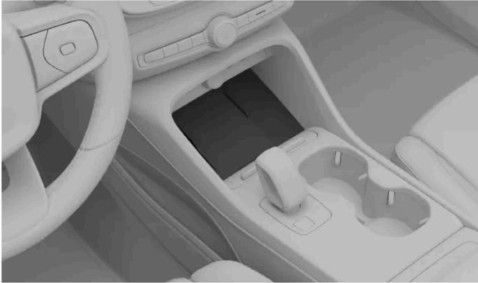
Pour utiliser un chargeur sans fil, votre appareil devrait être certifié avec la norme de recharge sans fil Qi. Assurez-vous aussi que la recharge sans fil est activée sur l'appareil<sup>[1]</sup> et le chargeur lui-même. Vous pouvez activer le chargeur dans l'écran central.
