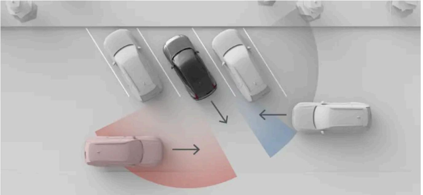
La situation illustrée dans cette image montre comment les objets environnants, tels que les voitures garées, peuvent limiter la capacité de la voiture à détecter les autres véhicules et les situations de circulation. En l'absence d'obstacles, les zones de détection actives sont les mêmes des deux côtés.
