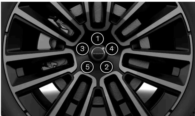
Serrez les boulons de roue en diagonale.
