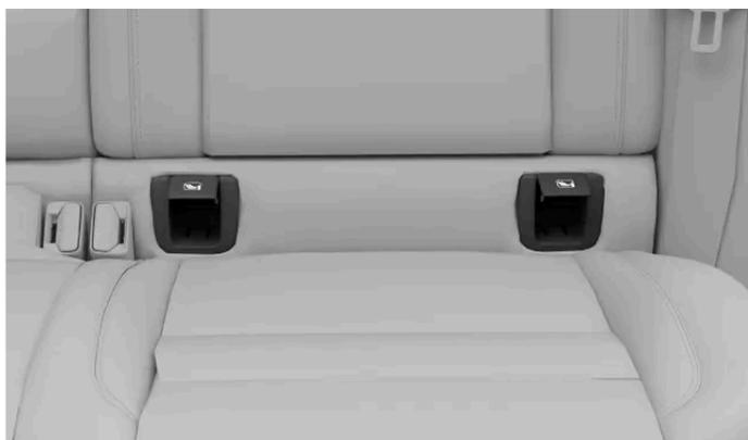
Emplacement des points d'ancrage ISOFIX<sup>[1]</sup> pour les sièges arrière extérieurs
