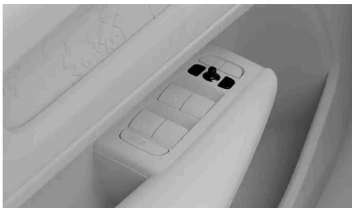
Commandes de réglage des rétroviseurs extérieurs
