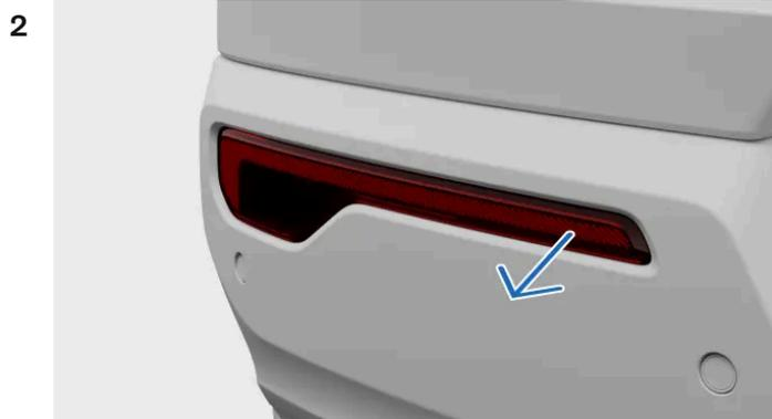
Insérez un tournevis derrière le côté court le plus étroit du feu antibrouillard et faites levier pour l'extraire.
