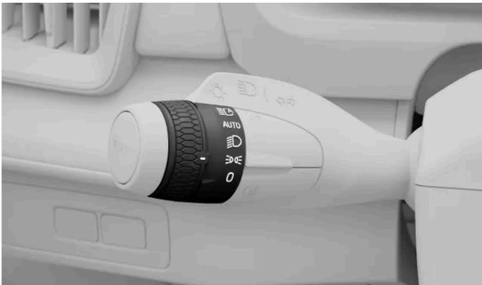
Le symbole des feux de position sur la bague rotative du levier gauche
