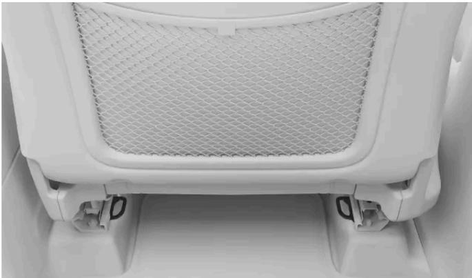
Les points d'ancrage inférieurs se trouvent à l'arrière des rails de plancher des sièges avant.
