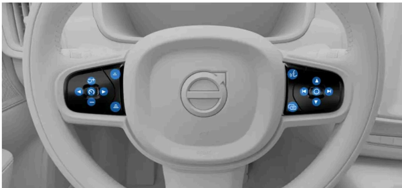
Les commandes situées sur le côté gauche du volant permettent de commander les fonctions d'aide au conducteur.
