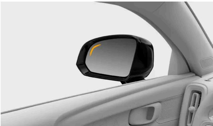
Lorsqu'un véhicule est détecté dans votre angle mort ou qu'il s'en approche, une lumière apparaît dans le rétroviseur extérieur.
