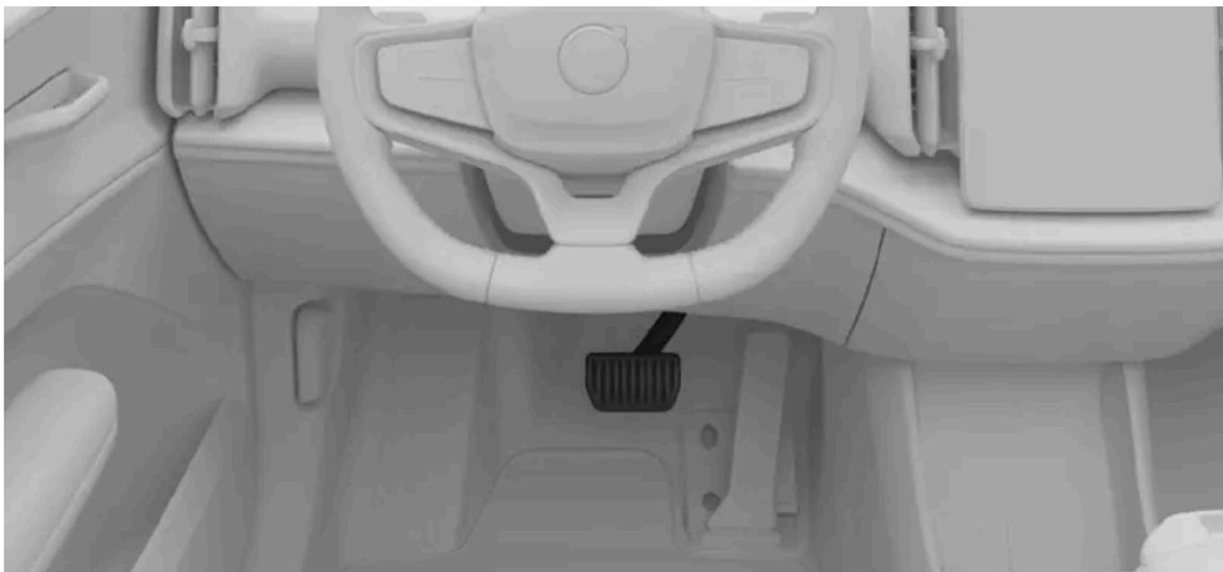
Le frein à pied engage le freinage par récupération ou les freins à friction, selon la façon dont vous appuyez sur la pédale. Un freinage léger active le freinage par récupération et un freinage plus robuste engage les freins à friction.
