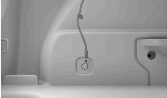
➤ Le câble de recharge se déverrouille de la prise.
