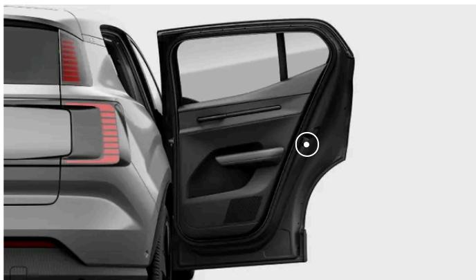
Emplacement du mécanisme de verrouillage sécurité enfant.
