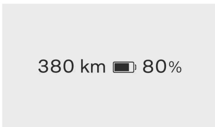
L'indicateur de charge est affiché en permanence dans la zone d'information du conducteur. La couleur de l'icône de la batterie change en fonction du niveau de charge restant dans la batterie.
