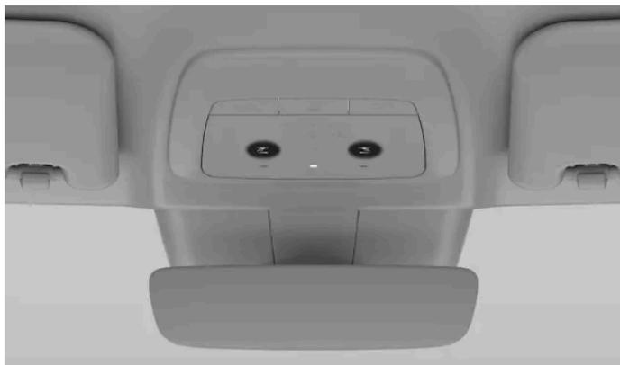
Les lampes de lecture des sièges avant dans la console au pavillon
