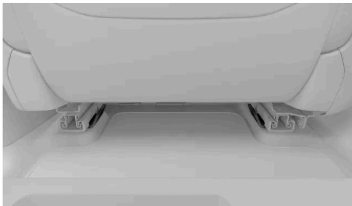
Les points d'ancrage inférieurs pour les sièges arrière se trouvent à l'arrière des longerons de châssis des sièges avant.
