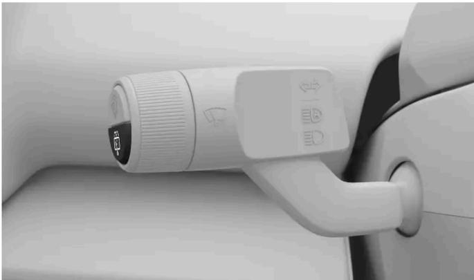
Vous commandez l'essuie-glace arrière à l'aide du bouton inférieur situé sur le levier gauche du volant.
