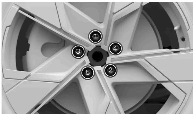
Serrez les boulons de roue en diagonale.
