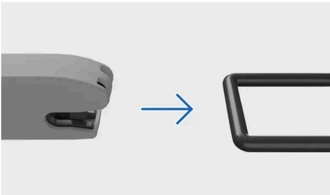
Fixation au point d'ancrage ISOFIX<sup>[1]</sup>
