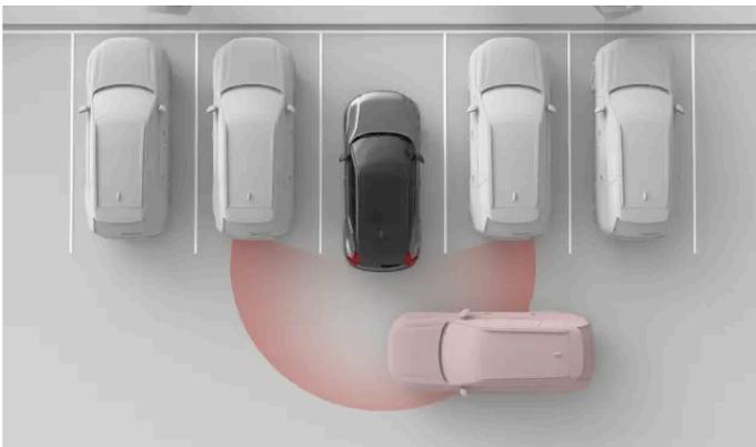
Les fonctions suivantes sont conçues pour intervenir lorsque la voiture détecte un risque de collision en marche arrière.
