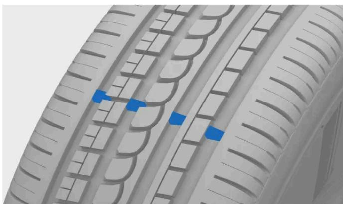
Les rainures étroites qui s'étendent sur toute la longueur de la bande de roulement du pneu sont des indicateurs d'usure. Vous trouverez sur le flanc du pneu les lettres TWI (Tread Wear Indicator)<sup>[1]</sup>.
