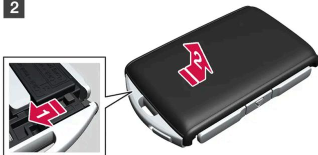
Glisser le fermoir qui se trouve derrière l'enveloppe avant vers le côté, puis glisser l'enveloppe arrière à l'écart du support d'anneau de clé.
