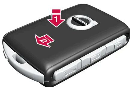
Reposer l'enveloppe avant dans l'ordre inverse. Presser sur l'enveloppe jusqu'au déclic, puis glisser l'enveloppe de quelques millimètres jusqu'à sa position d'origine.
