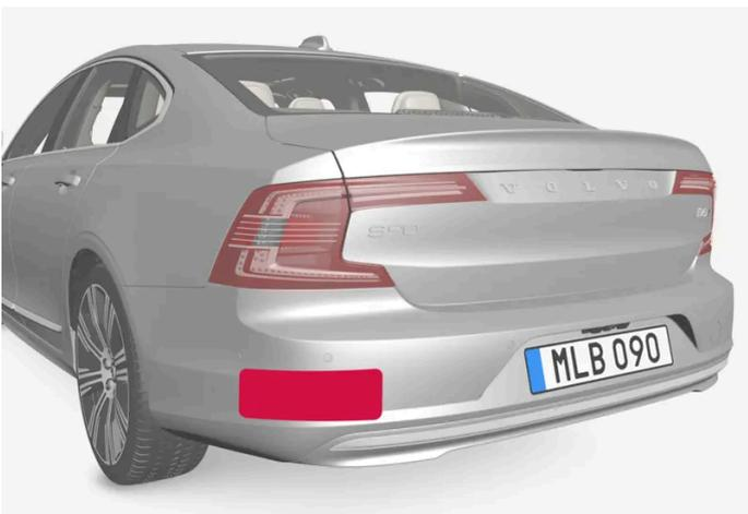
Emplacement des capteurs radar
