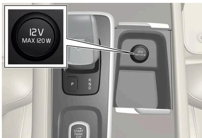
Prise électrique avant de la console de tunnel des voitures sans chargeur de téléphone sans fil\*.
