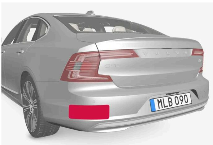
Emplacement des capteurs radar
