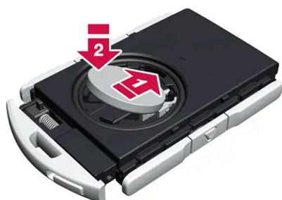
Insérer une nouvelle pile avec le côté positif (+) dirigé vers le haut. Ne pas toucher les surfaces de contact de la pile de la clé.
