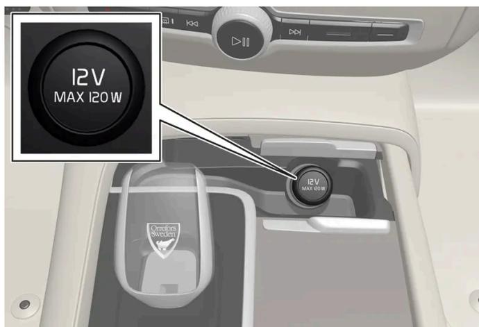
Prise électrique avant de la console de tunnel des voitures avec chargeur de téléphone sans fil\*.
