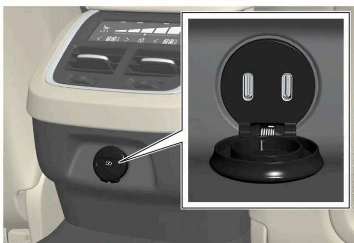
Ports USB (type C) dans la console de tunnel, siège arrière.
