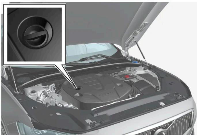
Tuyau de remplissage<sup>[1]</sup> <sup>[2]</sup>
