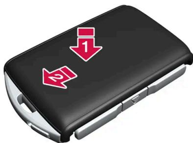
Reposer l'enveloppe arrière dans l'ordre inverse. Il n'y a aucun logo sur l'enveloppe arrière. Presser sur l'enveloppe jusqu'au dé clic, puis glisser l'enveloppe de quelques millimètres jusqu'à sa position d'origine.
