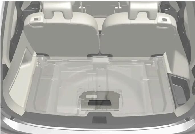
Les voitures hybrides légères sont dotées d'une batterie de soutien de 48 V située sous l'espace de chargement. La batterie et son boîtier doivent uniquement être manipulés par le personnel d'un atelier agréé.
