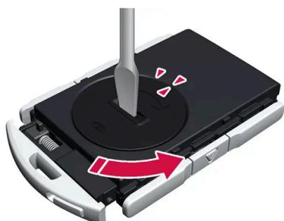
Tourner le couvercle de la pile dans le sens antihoraire jusqu'en position OPEN. Utiliser entre autres un tournevis ou une pièce de monnaie.
