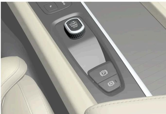
Bouton de démarrage de la console de tunnel.
