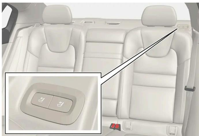
Boutons de rabattement des sièges, placés sur la partie supérieure du siège arrière gauche.
