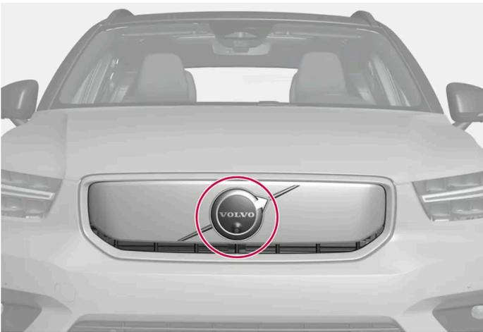
Emplacement du capteur radar avant
