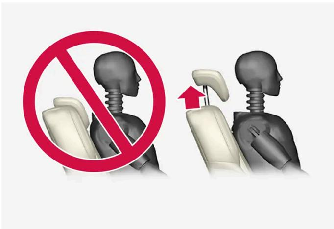
L'appuie-tête central doit être réglé pour la hauteur de passager. Tout l'arrière de la tête doit être couvert si possible. Déplacer manuellement le système de protection vers le haut ou le bas selon les besoins.
