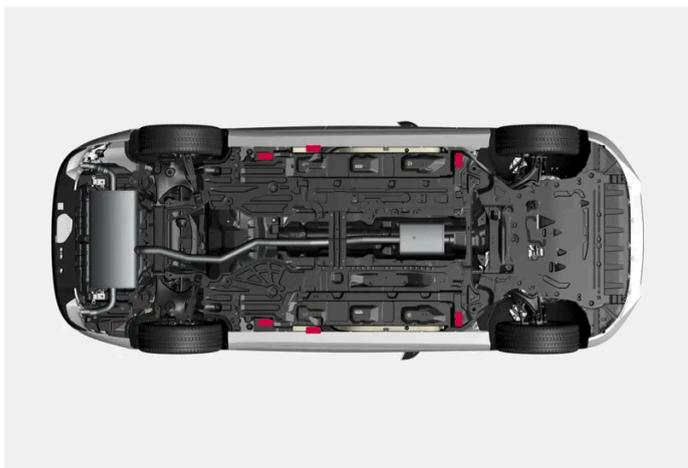
La voiture est dotée de points de levage extérieurs pour les levages bas, et de points de levage intérieurs pour les levages plus élevés, comme un cric d'atelier ou des bras de levage.
