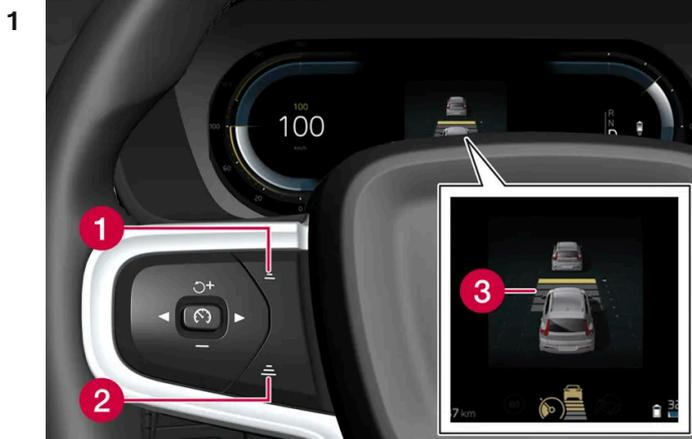
1 Commandes de paramétrage d'un intervalle de temps.
