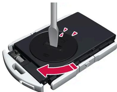
Remettre en place le couvercle de la pile et tourner dans le sens horaire jusqu'en position CLOSE.
