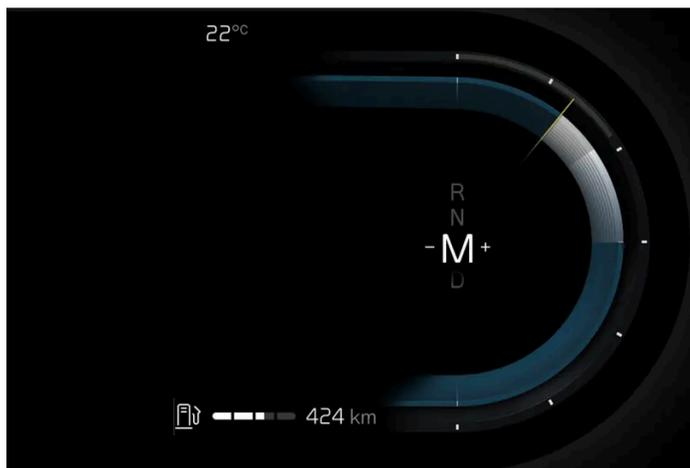
En position M, il est possible de changer de rapport manuellement. Le frein moteur fonctionne lorsque la pédale d'accélérateur est relâchée.
