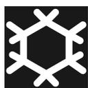
Quand la température extérieure se situe entre  $-5\text{ °C}$  ( $23\text{ °F}$ ) et  $+2\text{ °C}$  ( $36\text{ °F}$ ), un symbole de flocon de neige s'allume pour avertir du risque de conditions glissantes.
