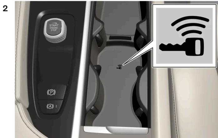
Placer la clé sur le pictogramme de clé dans le lecteur de sauvegarde, dans le porte-gobelet de la console à tunnel.
