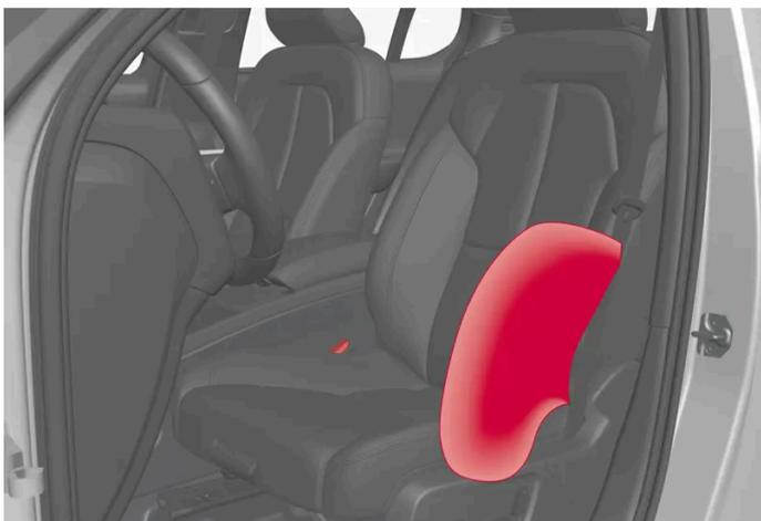
Les coussins gonflables côté impact sont montés dans les encadrements extérieurs des dossiers des sièges avant et contribuent à protéger le conducteur et le passager avant.
