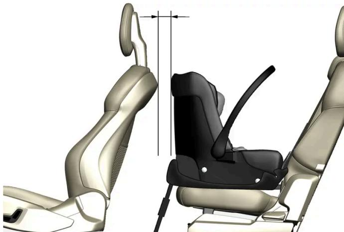
Pour l'installation d'un siège pour bébé dans le siège arrière, Volvo recommande de garder une distance d'au moins 50 mm (2 pouces ) entre la partie avant du siège pour bébé et la partie la plus en arrière du siège devant.
