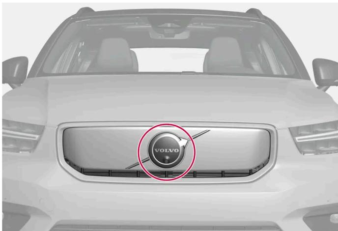
Emplacement du capteur radar avant
