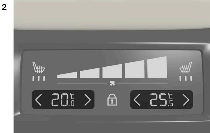
Commandes de température du panneau de climatisation arrière de la console de tunnel.
