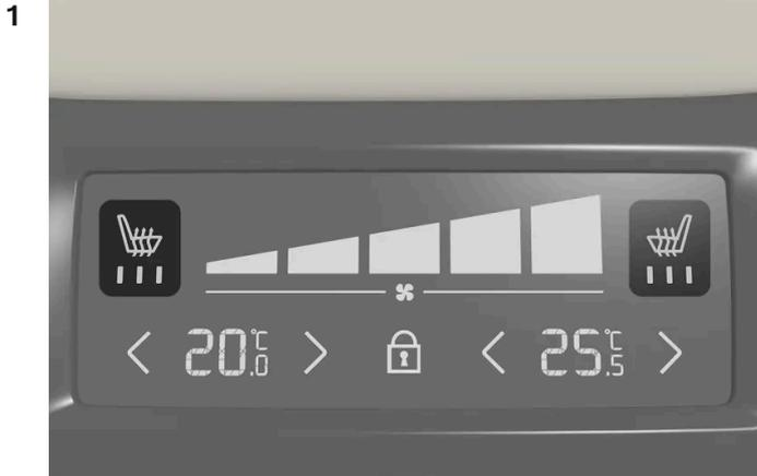
Commandes de chauffage de siège et lampes indicatrices sur l'arrière de la console de tunnel.
