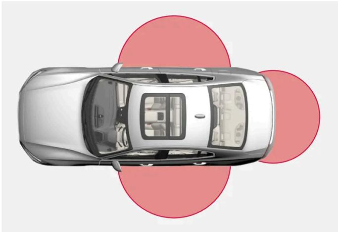
Pour l'utilisation de la fonction sans clé, une clé doit se trouver à une distance d'environ 1 à 1,5 mètre (3 à 5 pieds) d'une porte ou du couvercle de coffre de la voiture.
