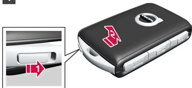
Glisser le fermoir du support d'anneau de clé sur le côté, et glisser l'enveloppe avant à l'écart du support.
