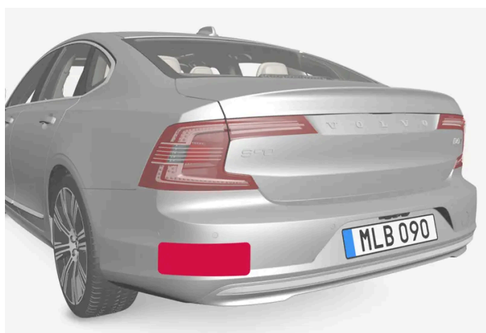
Emplacement des capteurs radar
