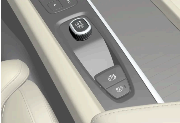
Bouton de démarrage de la console de tunnel.
