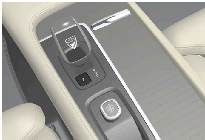
Vue d'ensemble du levier de vitesse et de la position P.
