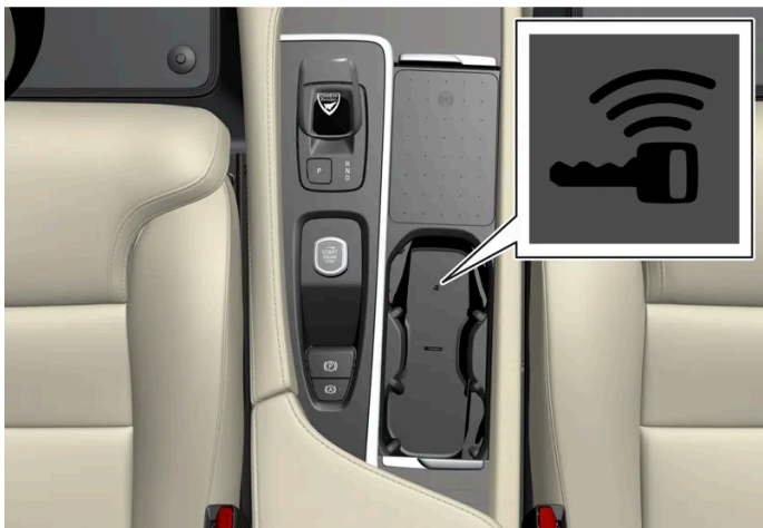
Emplacement du lecteur de secours dans la console de tunnel.
