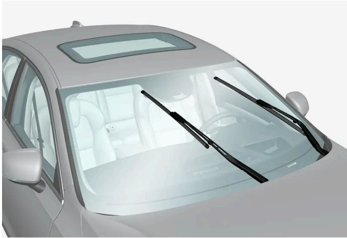
Balais d'essuie-glaces en position d'entretien.
