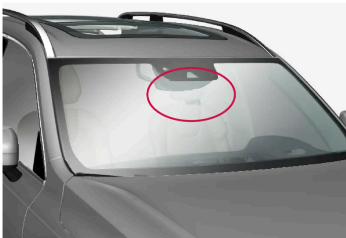
Emplacement de la caméra avant
