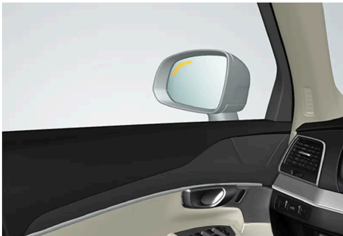
Emplacement de la lampe indicatrice BLIS
