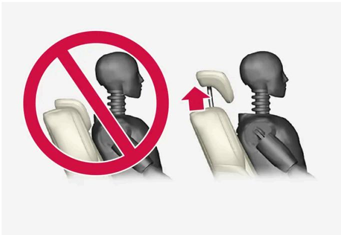
L'appuie-tête central doit être réglé pour la hauteur de passager. Tout l'arrière de la tête doit être couvert si possible. Déplacer manuellement le système de protection vers le haut ou le bas selon les besoins.
