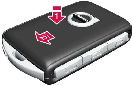
Tourner la clé et remettre en place l'enveloppe avant de la même manière que l'enveloppe arrière.
