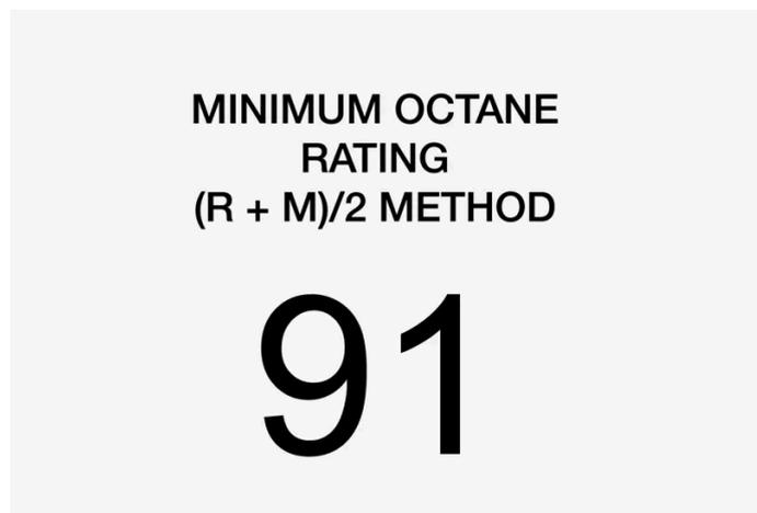
Illustration 1: exemple d'étiquette d'indice d'octane<sup>[1]</sup> sur une pompe à carburant.
