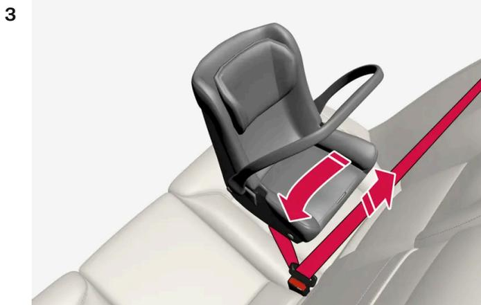
Acheminer la ceinture de sécurité à travers le siège pour nourrisson.
