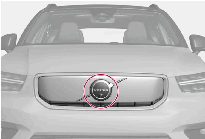
Emplacement du capteur radar avant
