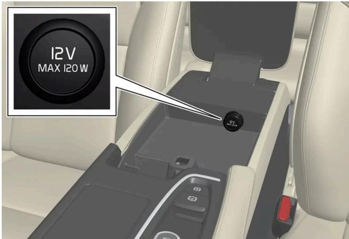
Prise 12 V dans la console de tunnel, de siège avant.
