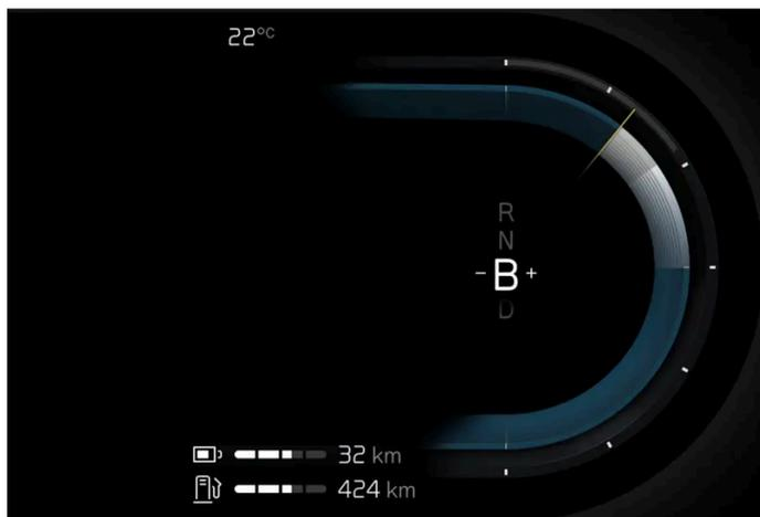
Vue d'ensemble des positions de freinage sur l'écran du conducteur.
