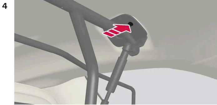
Visser la vis prévue en place en utilisant la clé Allen prévue de 6 mm. Répéter l'opération de l'autre côté. Couple recommandé : 20 Nm (15 lb-pi)
