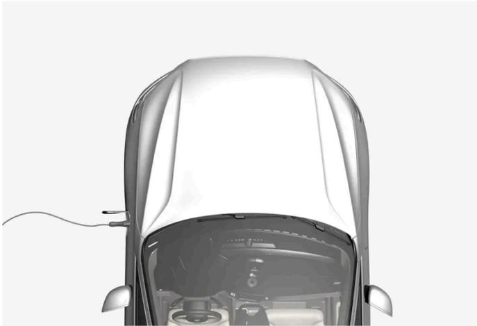
La batterie hybride est rechargée en utilisant le câble de chargement. Elle peut être rechargée pendant un léger freinage et lorsque le frein moteur est en position B. Le moteur thermique peut également contribuer à recharger la batterie hybride. La batterie de démarrage de la voiture est rechargée pendant la charge de la batterie hybride.
