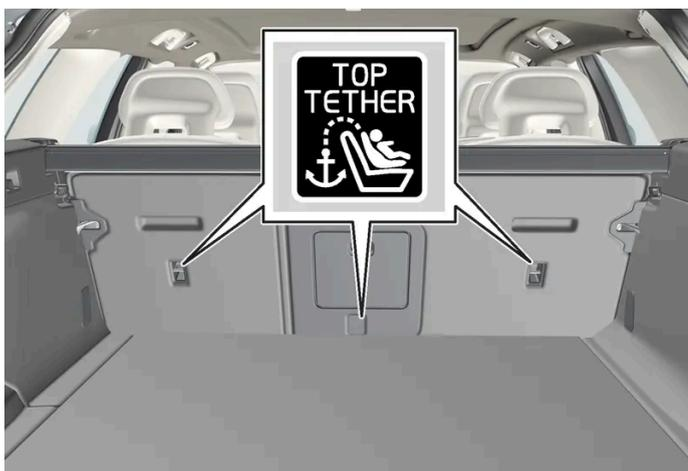
Ancrages d'attache supérieurs et symboles sur la face arrière des dossiers de sièges arrière.
