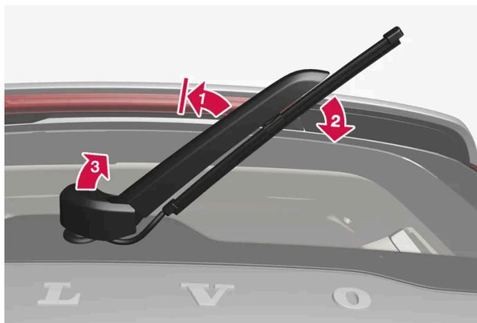
Soulever le bras d'essuie-glace pour l'éloigner du pare-brise et tirer la partie supérieure du balai diagonalement en bas vers la droite.
