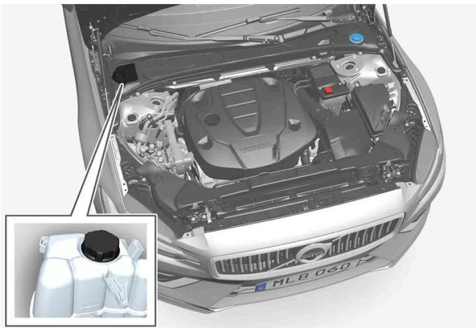
Réservoir de dilatation du liquide de refroidissement
