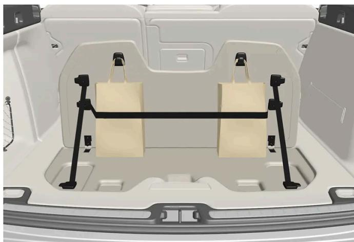
Il existe deux dispositifs d'arrimage de sacs d'épicerie et une bande élastique<sup>[1]</sup> dans la trappe du plancher du compartiment à bagages. La sangle peut être fixée à quatre positions différentes.
