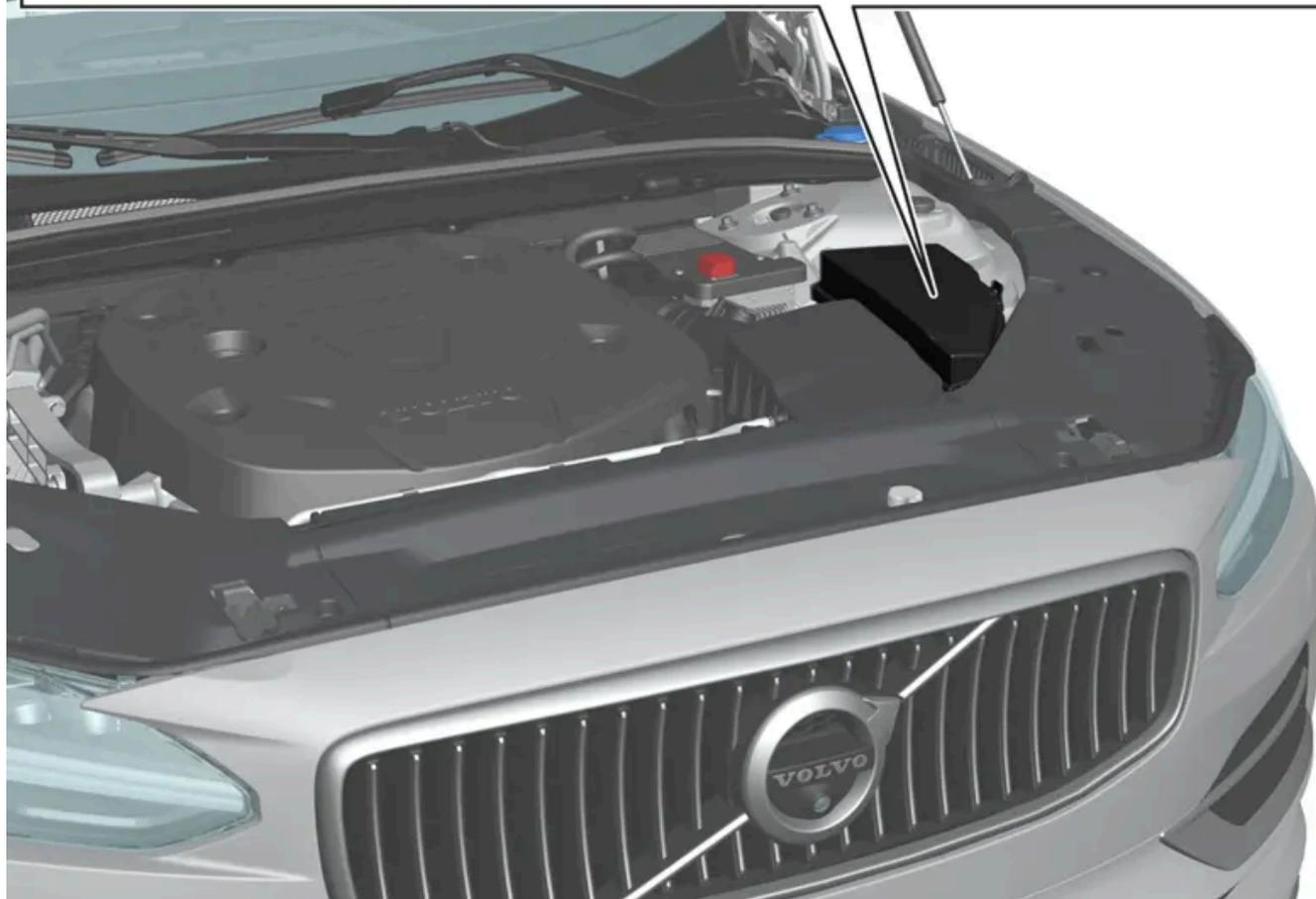
Une pince spéciale, rangée à l'intérieur du couvercle, facilite le remplacement des fusibles grillés.
