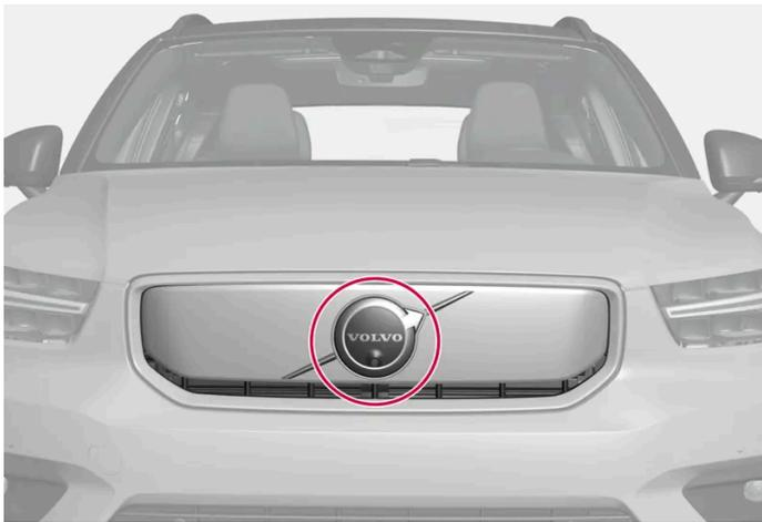
Emplacement du capteur radar avant
