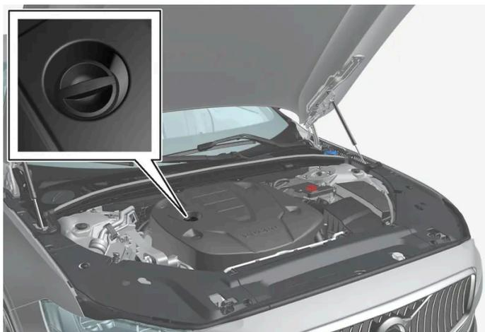
Tuyau de remplissage<sup>[1]</sup>,<sup>[2]</sup>
