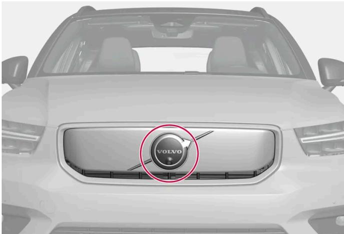
Emplacement du capteur radar avant
