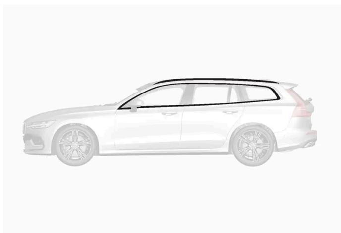
Composants devant être lavés avec un produit de nettoyage ayant un pH compris entre 3,5 et 11,5
