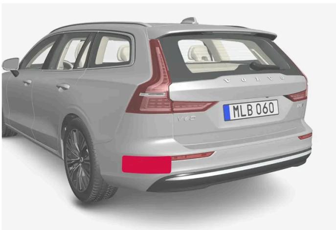
Emplacement des capteurs radar
