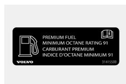
Illustration 2 : autocollant à l'intérieur de la trappe à remplissage de carburant sur les véhicules qui exigent du carburant de première qualité<sup>[2]</sup>.
