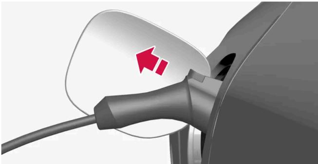
Appuyer sur le bouton de déverrouillage de la poignée de câble de charge. La poignée se relâche/se déverrouille. Débrancher le câble de la prise de charge du véhicule et fermer le volet du chargeur.
