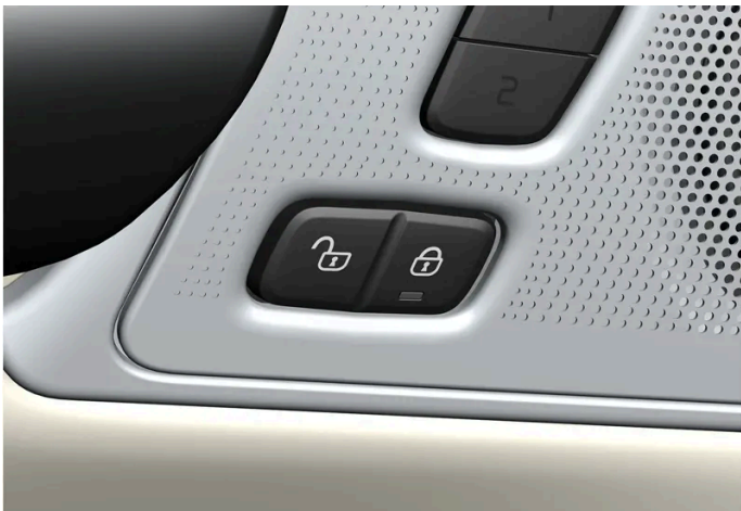
Boutons de verrouillage avec lampes indicatrices dans la porte avant.
