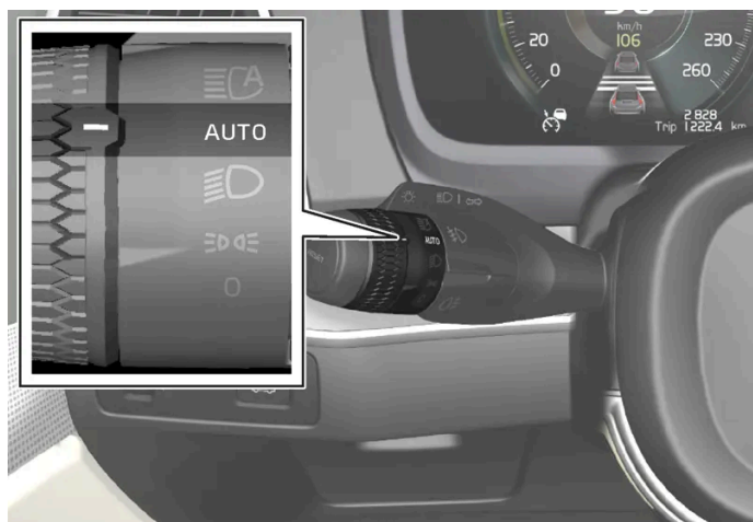
Bague d'éclairage en position AUTO .
