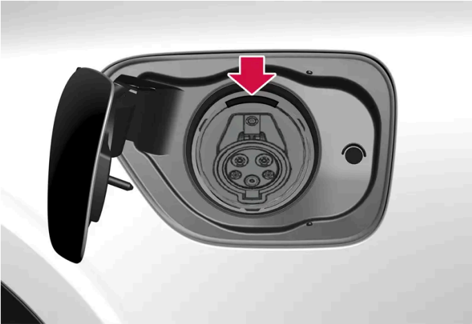
Emplacement de la lampe indicatrice LED dans la prise de charge du véhicule.
