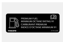
Illustration 2 : autocollant à l'intérieur de la trappe à remplissage de carburant sur les véhicules qui exigent du carburant de première qualité [2] .
