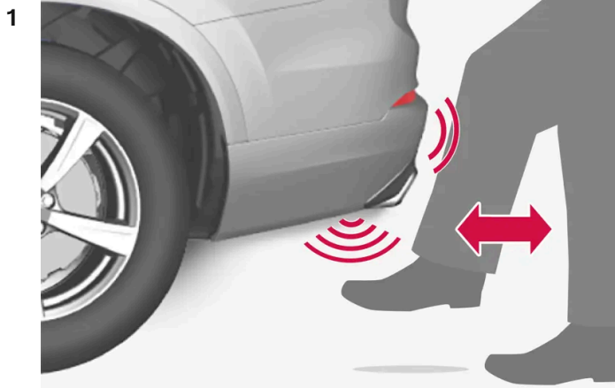
Mouvement du pied dans la zone d'activation du capteur.
