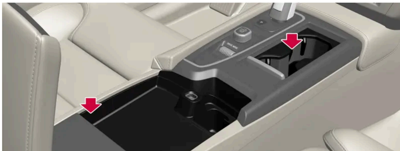
Compartiments de rangement avec porte-gobelet, prise électrique et prises USB dans la console de tunnel.
