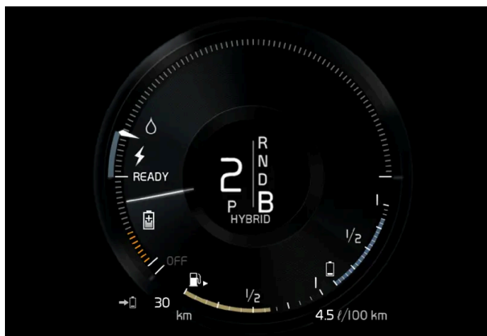
Indication dans l'écran du conducteur pendant la récupération d'énergie.
