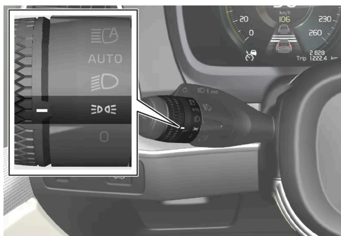
Bague d'éclairage en position de feu de stationnement.
