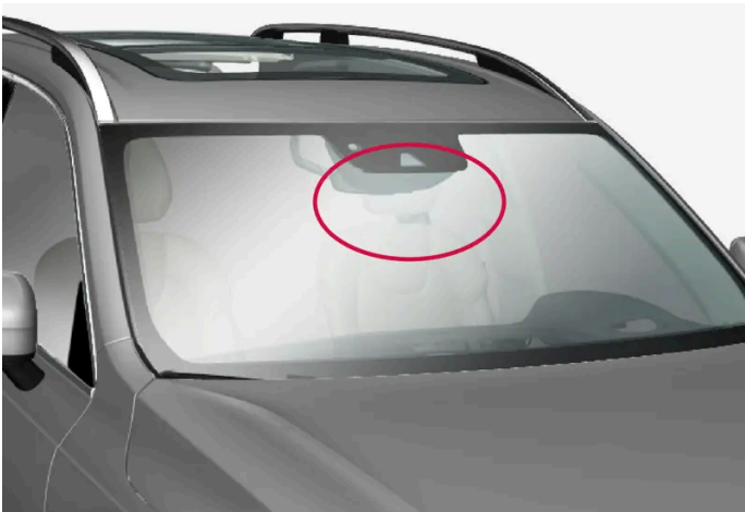
Emplacement du capteur radar avant
