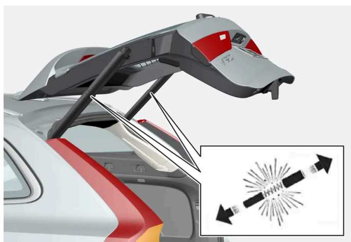
Ressorts préchargés du hayon à commande électrique.
