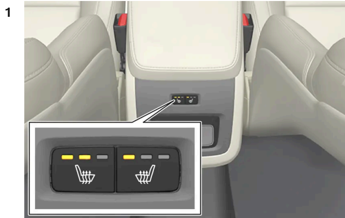
Boutons du siège chauffant sur la face arrière de la console de tunnel
