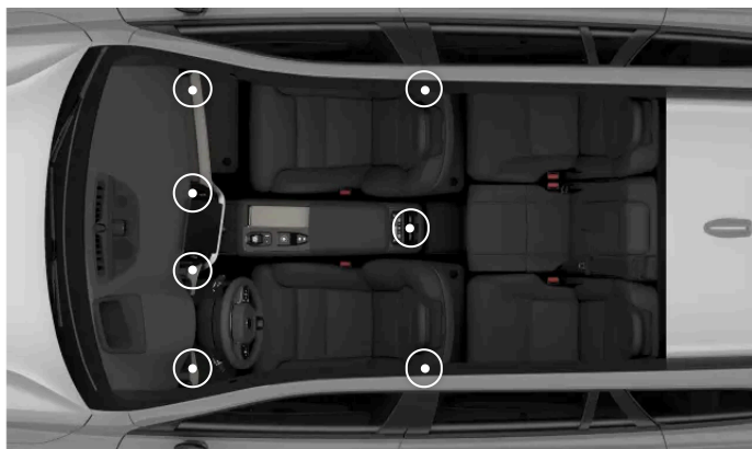
Emplacements des bouches d'air réglables
