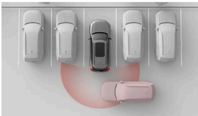
Les fonctions suivantes sont conçues pour intervenir lorsque la voiture détecte un risque de collision en marche arrière.
