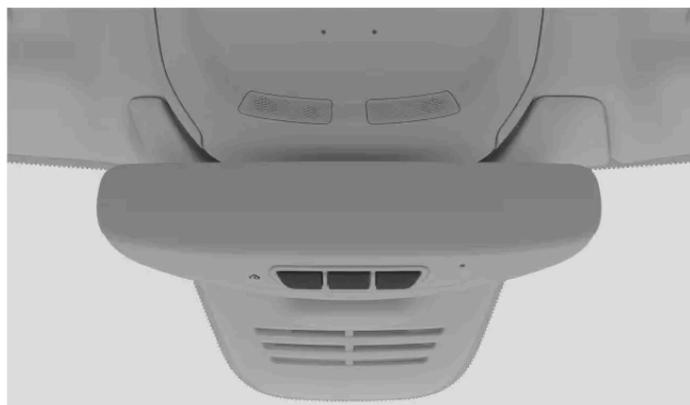
HomeLink est intégré au rétroviseur intérieur et se compose de trois boutons et d'un témoin. Vous pouvez connecter un appareil par bouton. Il est possible d'ajouter, de modifier ou de supprimer une connexion à un appareil.
