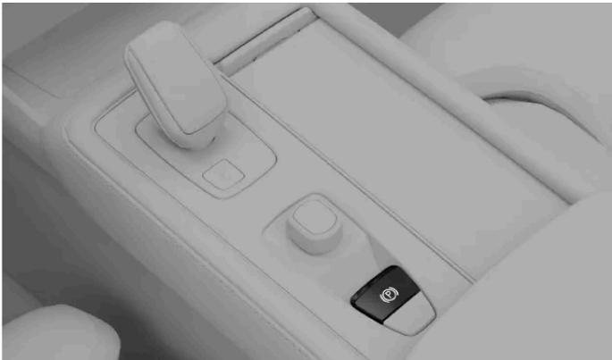
Engagez manuellement le frein de stationnement en tirant sur l'interrupteur du frein de stationnement.
