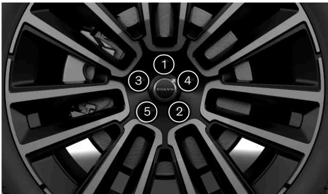
Serrez les boulons de roue en diagonale.
