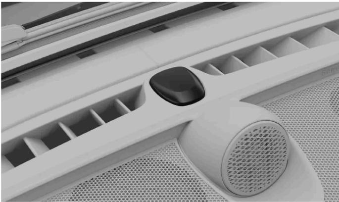
L'indicateur d'alarme est un témoin situé au centre du tableau de bord, juste devant le pare-brise. Le témoin confirme quand l'alarme est activée avec un voyant clignotant rouge.
