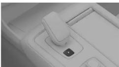
Lorsque P est sélectionné, la boîte de vitesses est bloquée mécaniquement pour éviter les changements de vitesse accidentels.
