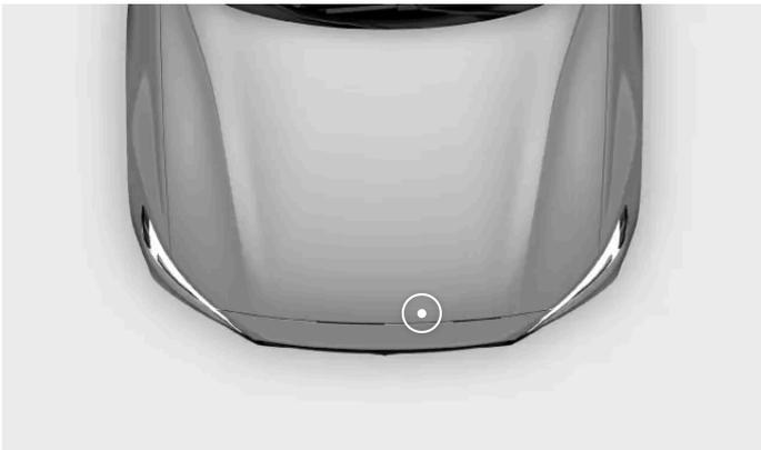
Le deuxième levier se trouve sous le bord avant du capot, côté conducteur.
