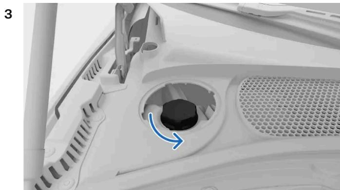
Dévissez le couvercle du réservoir de liquide de refroidissement.
