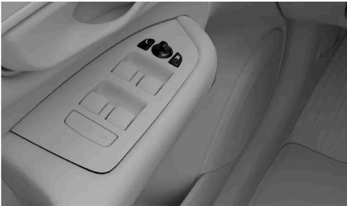
Commandes de réglage des rétroviseurs extérieurs
