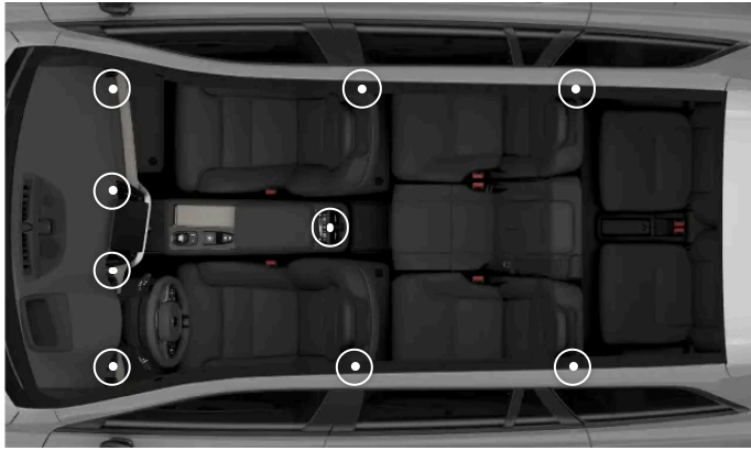
Emplacements des bouches d'air réglables
