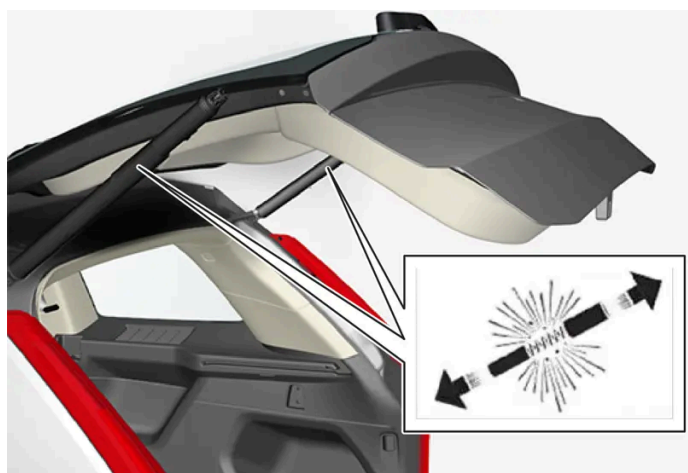
Ressorts préchargés du hayon à commande électrique.
