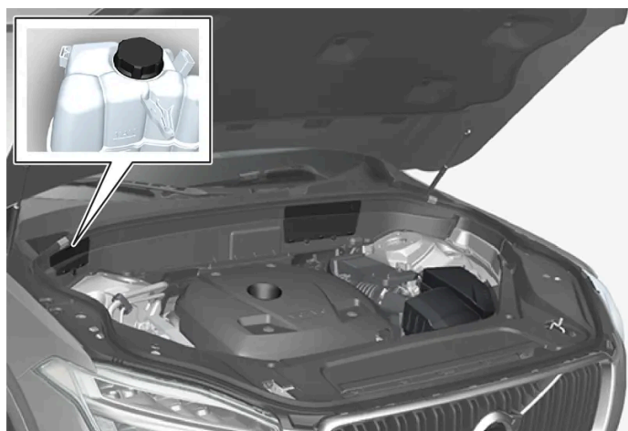
Réservoir de dilatation du liquide de refroidissement
