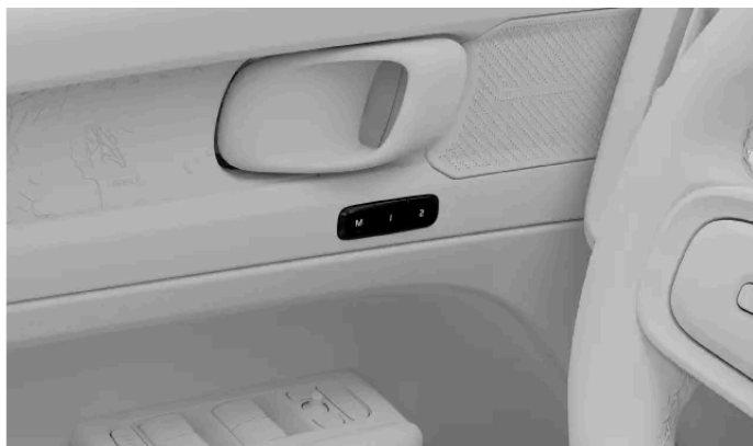
Umístění tlačítek předvolených nastavení sedadel
