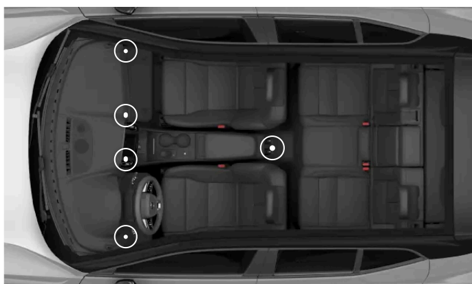
Rozmístění nastavitelných ventilačních otvorů
