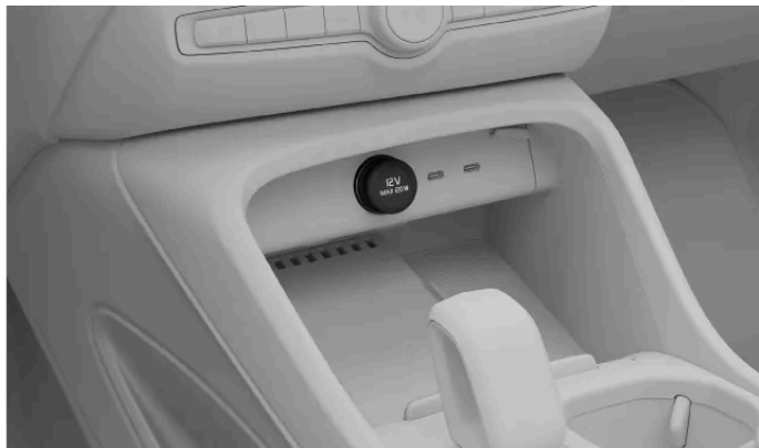
12V elektrická zásuvka v tunelové konzole
