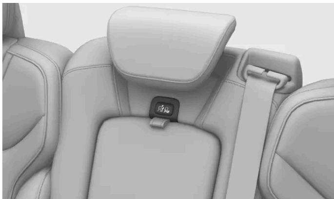
Blokovací tlačítko na prostřední hlavové opěrce
