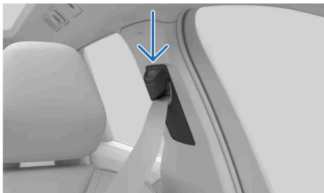
Horní kotevní bod bezpečnostního pásu
