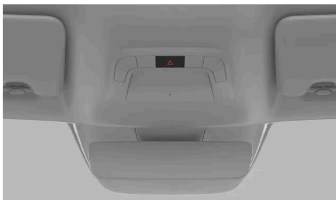
Umístění tlačítka výstražných světel na stropním panelu
