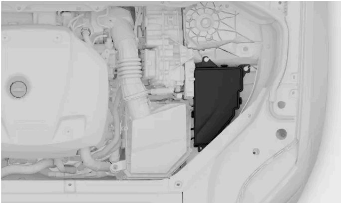
Umístění pojistkové skříňky
