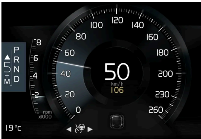
Indikace řazení na 8" displeji řidiče u velké řadicí páky.
