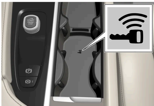
Umístění záložní čtečky v tunelové konzole.
