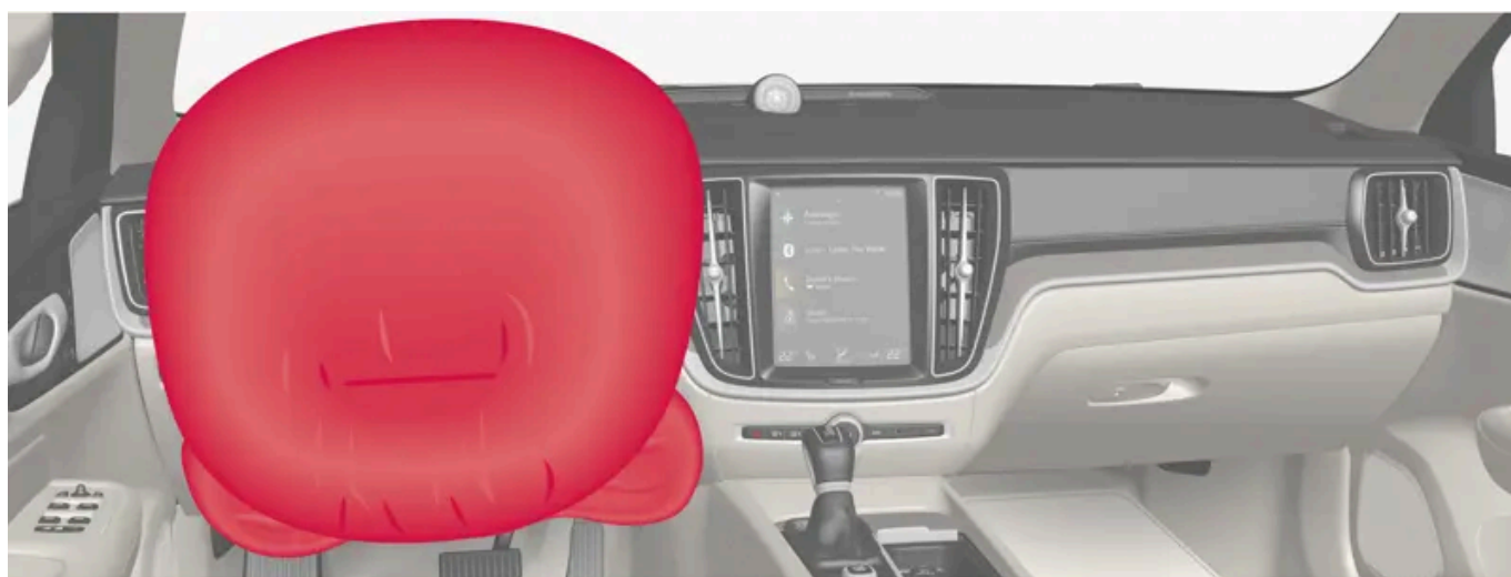
Airbag ve volantu a kolenní airbag [1] na straně řidiče na předním sedadle.
