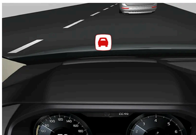
Symbol varování před kolizí na čelním skle
