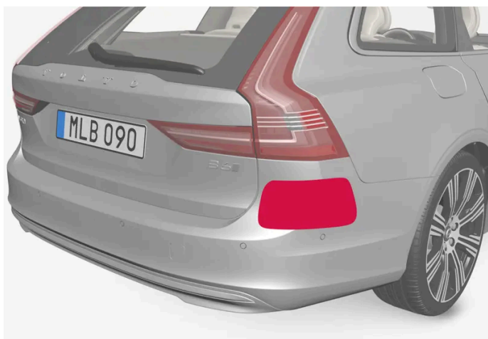
Umístění zadních radarových jednotek
