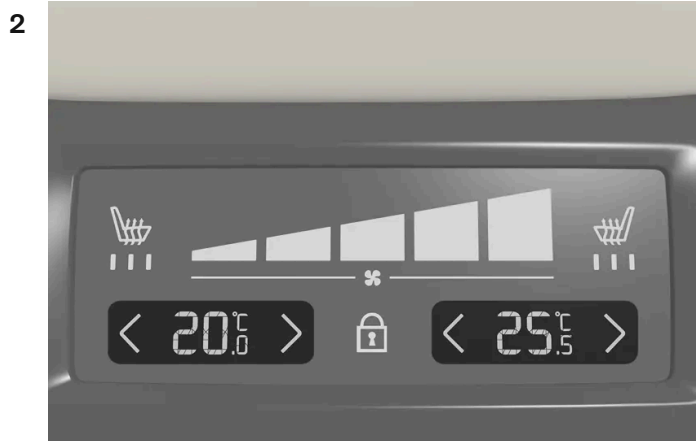
Ovládání teploty na panelu klimatu na zadní straně tunelové konzoly.
