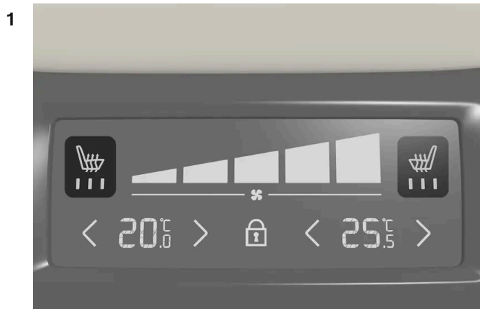
Indikace vyhřívání sedadla a ovládací prvky na panelu klimatu ze zadní strany tunelové konzoly.
