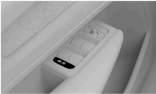
Position der Kindersicherungstaste in der Türverkleidung
