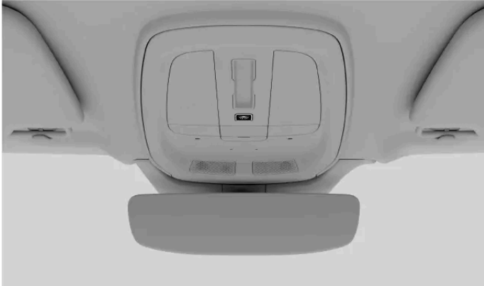
Die Taste zum Deaktivieren der automatischen Beleuchtung an der Deckenkonsole
