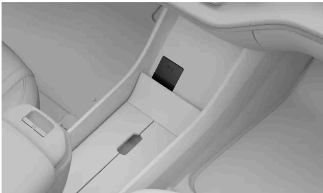
Lage des Schlüsselkartenlesers, der beim Starten des Fahrzeugs mit einer Schlüsselkarte oder einem entladenen Schlüssel zur abstandsasierten Ver- und Entriegelung zum Einsatz kommt.
