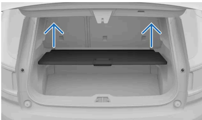
Abbildung zum Herausnehmen der Bodenklappe im Kofferraum.
