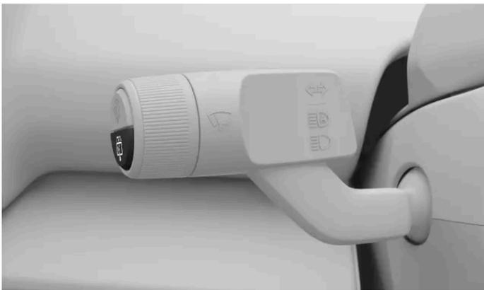
Sie bedienen den Heckscheibenwischer mit der unteren Taste am linken Lenkradhebel.
