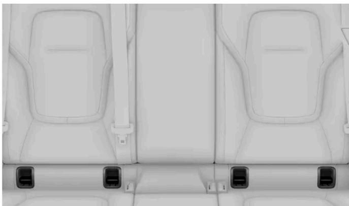
Die ISOFIX-Verankerungspunkte im Fond befinden sich unter einer Klappe im unteren Teil der Rückenlehnen der äußeren Rücksitze. Sie müssen die Klappe öffnen, um an die dahinterliegenden Verankerungspunkte zu kommen.
