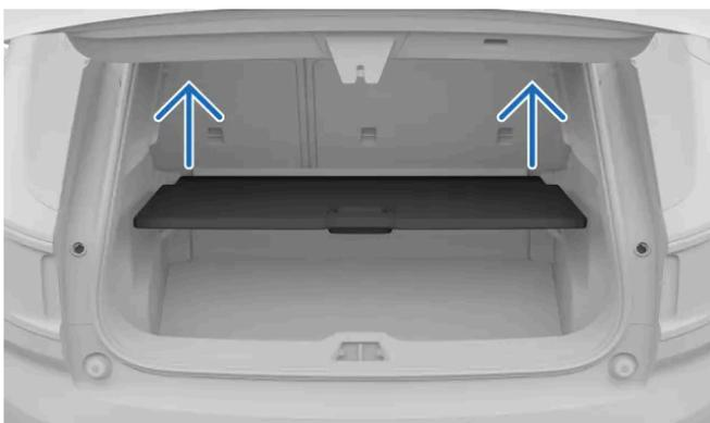
Abbildung zum Herausnehmen der Bodenklappe im Kofferraum.
