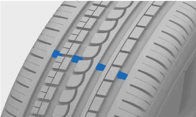
Der Verschleiß wird mithilfe der schmalen Rillen angezeigt, die längs über das Reifenprofil verlaufen. An der Reifenflanke finden sich die Buchstaben TWI <sup>[1]</sup>.
