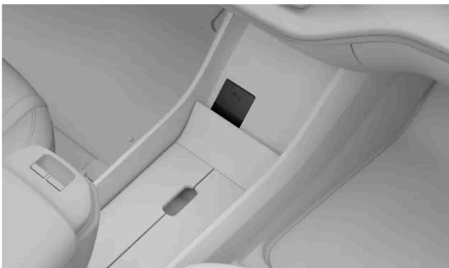
Lage des Schlüsselkartenlesers, der beim Starten des Fahrzeugs mit einer Schlüsselkarte oder einem entladenen Schlüssel zur abstands-basierten Ver- und Entriegelung zum Einsatz kommt.
