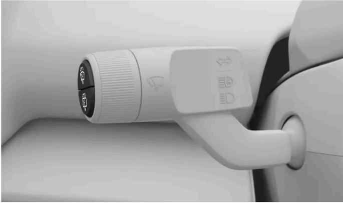
Tasten für die Scheibenwaschanlage am linken Lenkradhebel.
