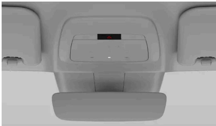
Die Lage der Taste für die Warnblinkanlage an der Deckenkonsole
