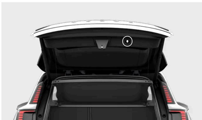
Lage der Taste zum Schließen der Heckklappe.
