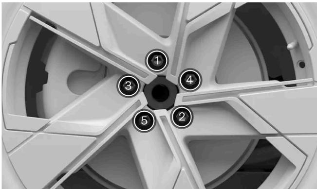
Ziehen Sie die Radmutter oder -schrauben über Kreuz an.
