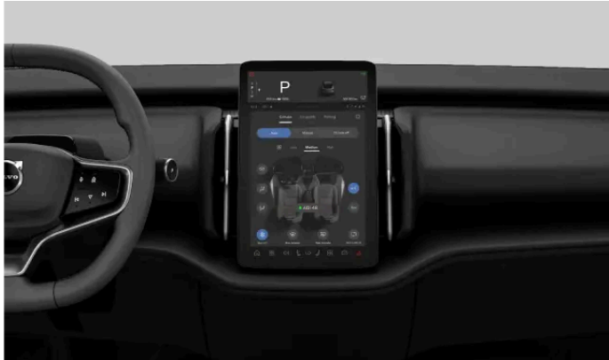
Bedienelemente der Klimaanlage auf dem Display
