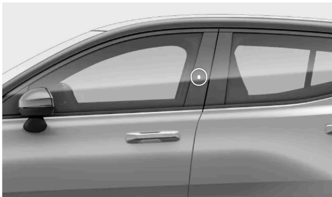
Schlüsselerkennungsbereich an der Türsäule
