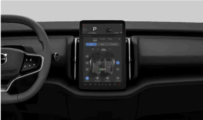
Bedienelemente der Klimaanlage auf dem Display
