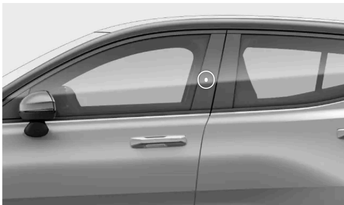
Schlüsselerkennungsbereich an der Fahrertürsäule.
