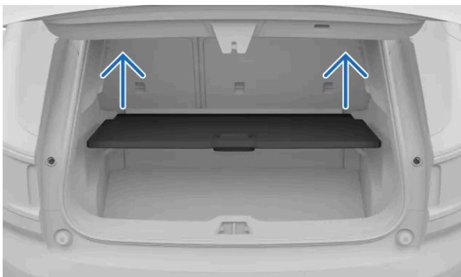
Abbildung zum Herausnehmen der Bodenklappe im Kofferraum.
