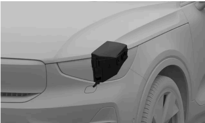
Lage des Sicherungskastens
