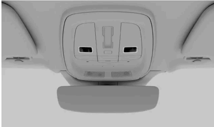
Die vorderen Leseleuchten an der Deckenkonsolle
