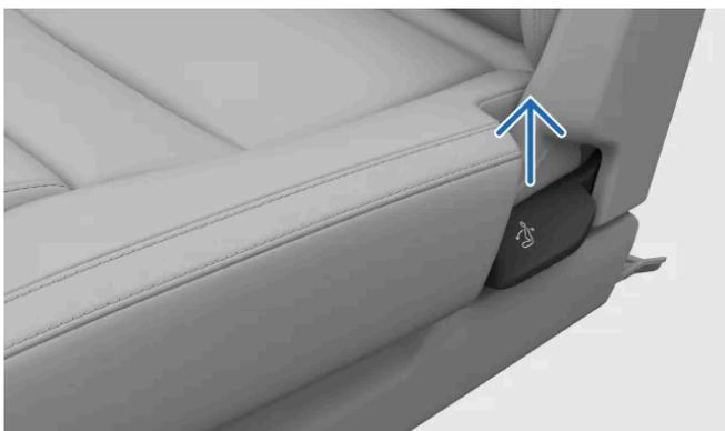
Ziehen Sie den Griff, der sich seitlich am Sitzpolster befindet, nach oben, um die Rückenlehne zu entsperren.
