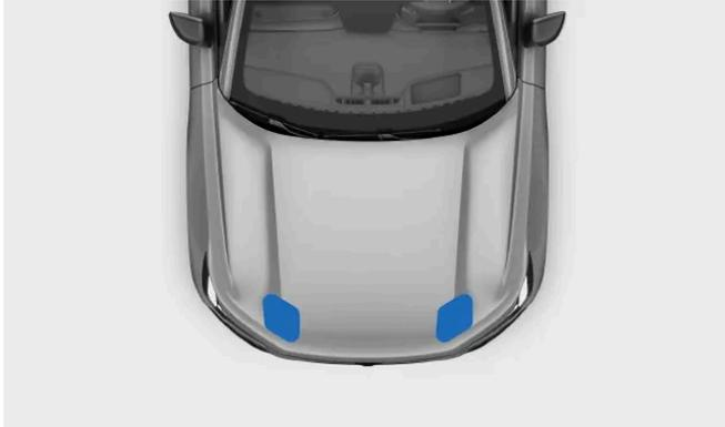
Stelle an der Frontklappe, an der sie zum Schließen heruntergedrückt wird
