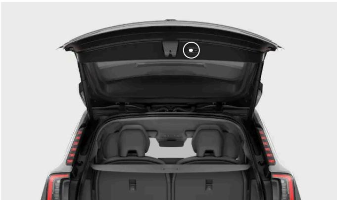
Lage der Taste zum Schließen der Heckklappe
