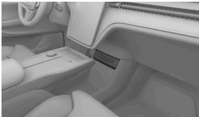
Zwei USB-Buchsen <sup>[1]</sup> befinden sich unter dem Center Display.
