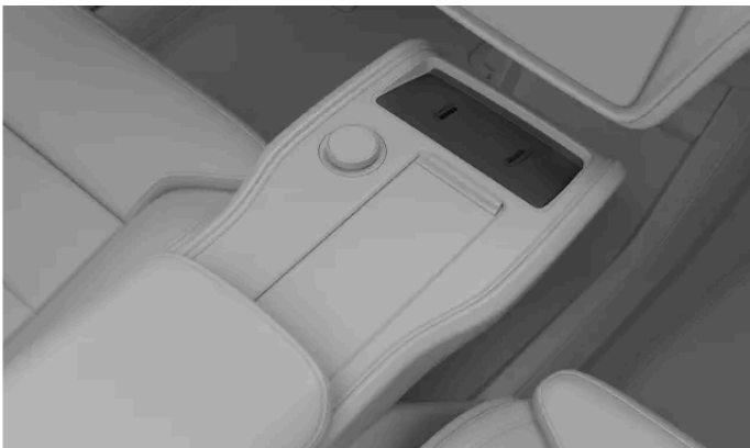
Der Kartenleser zwischen den Vordersitzen dient auch als kabellose Ladeablage.
