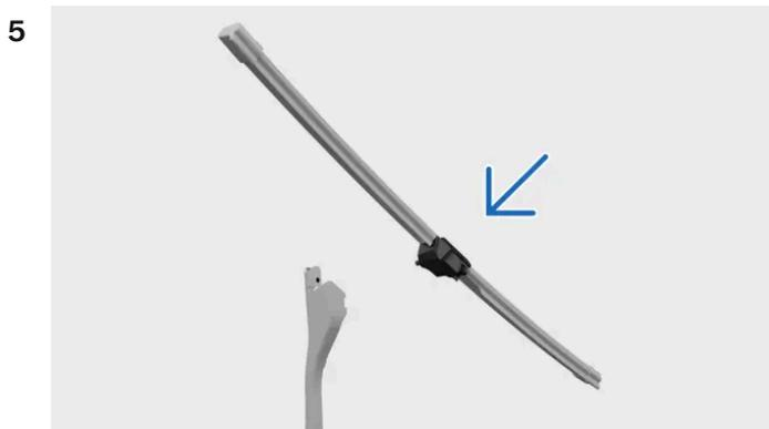
Beachten Sie, dass das Wischerblatt für die Fahrerseite länger ist als das für die Beifahrerseite. Halten Sie das neue Wischerblatt waagrecht und schieben Sie es auf den Wischerarm. Achten Sie darauf, dass der Stift am Wischerarm in die Öffnung am Wischerblatt greift.
