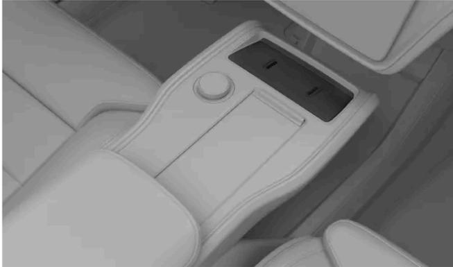
Lage des Schlüsselkartenlesers, der beim Starten des Fahrzeugs mit einer Schlüsselkarte oder einem entladenen Schlüssel zur abstands-basierten Ver- und Entriegelung zum Einsatz kommt.
