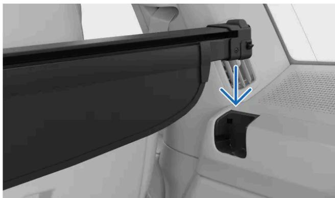
Drücken Sie die Laderaumabdeckung in die Vertiefungen, bis sie auf beiden Seiten einrastet. Kontrollieren Sie, dass die Verriegelungen der Abdeckung jeweils die rote Markierung verdecken.
