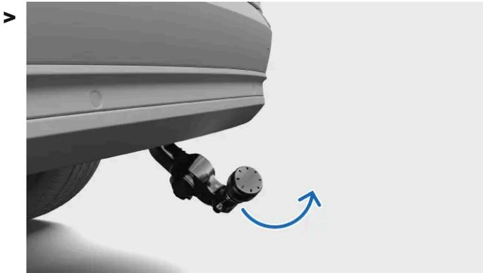
Die Anhängerkupplung ist ausgefahren. Während die Anhängerkupplung ausgefahren wird, blinkt das Symbol auf der Taste zum Ausfahren.
