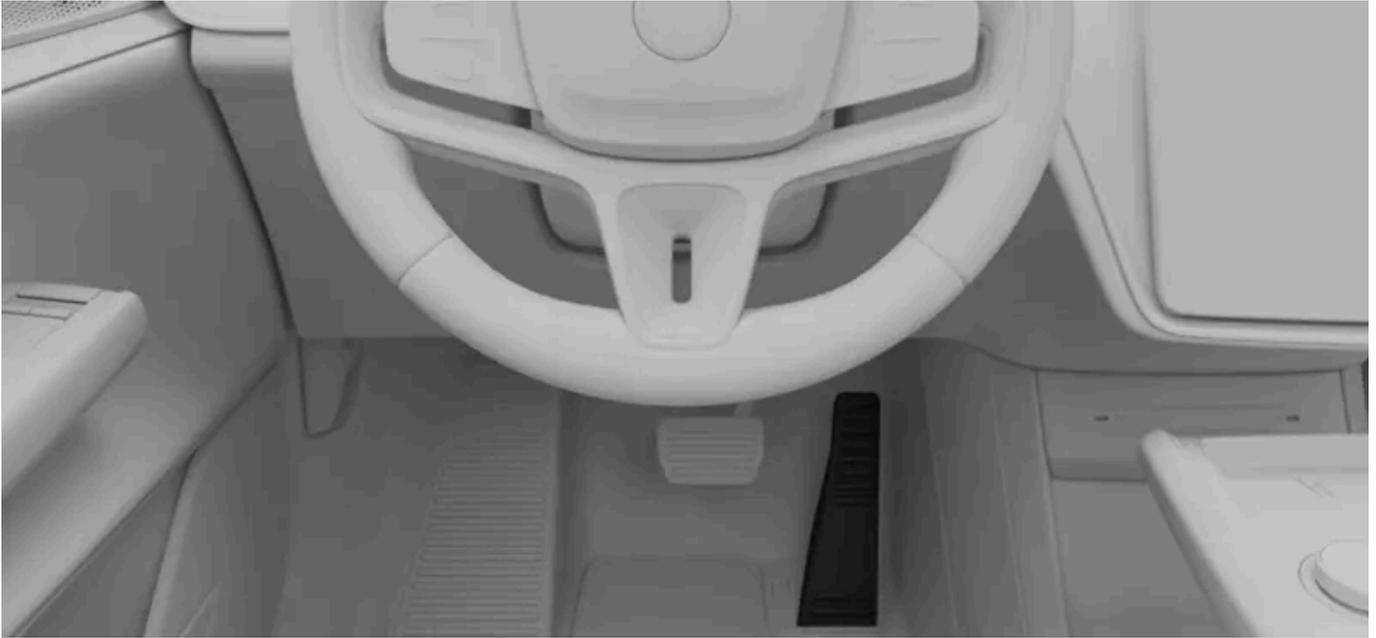
Je nachdem, wie Sie das Fahrpedal betätigen, ändert sich das Bremsverhalten. Beim Betätigen des Fahrpedals beschleunigt das Fahrzeug wie gewohnt, aber wenn Sie das Fahrpedal loslassen, wird stattdessen gebremst. Je weniger Sie das Pedal betätigen, desto stärker ist die Bremswirkung. Durch vollständiges Freigeben des Fahrpedals wird das Fahrzeug nach und nach zum Stehen gebracht.
