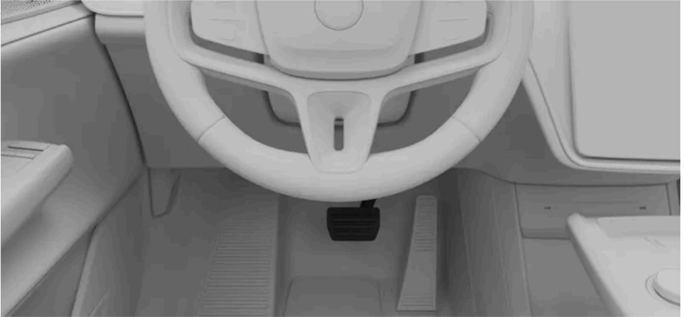
Je nachdem, wie fest Sie das Pedal treten, aktiviert die Betriebsbremse entweder die Bremsenergieerückgewinnung oder betätigt die Reibungsbremse. Leichtes Bremsen aktiviert die Bremsenergieerückgewinnung, stärkeres Bremsen betätigt die Friktionsbremsen.
