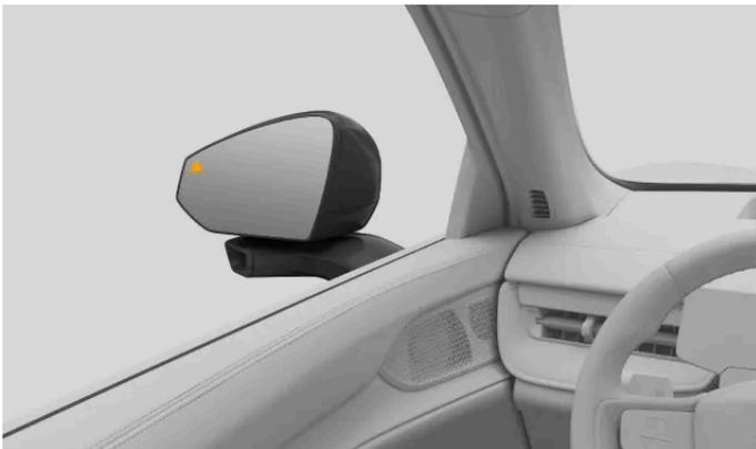
Wenn die Funktion ein Fahrzeug erkennt, das in kurzem Abstand am eigenen Fahrzeug vorbeifahren wird, schaltet sich eine Warnleuchte im Außenspiegel ein. Wenn Sie dann beginnen, auf der Seite mit dem erkannten Fahrzeug die Tür zu öffnen, verstärkt sich die Warnung. Je nachdem, wie dringend die Warnung ist, kann zu den optischen Signalen ein Warnton hinzukommen.
