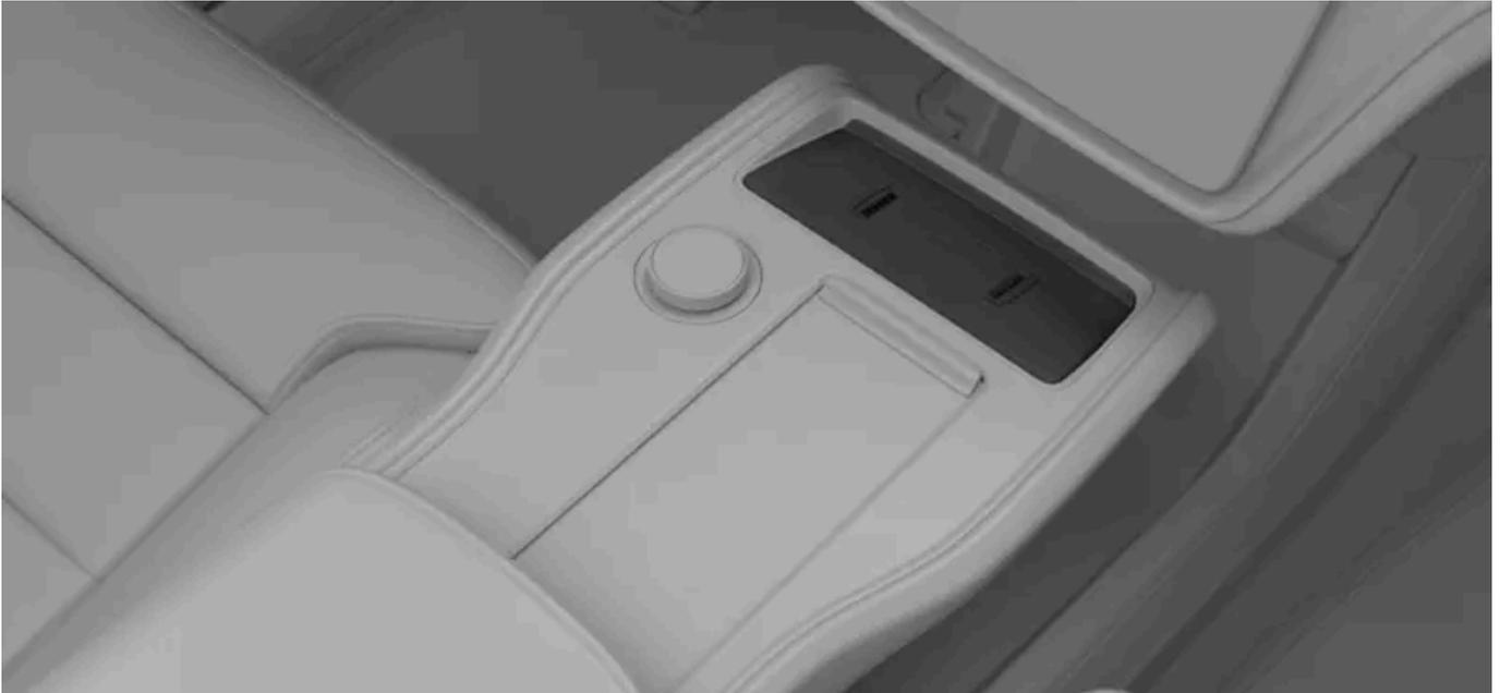
Um ein Gerät auf der kabellosen Ladeablage aufladen zu können, muss dieses für das kabellose Laden gemäß Qi-Standard zertifiziert sein. Außerdem muss das kabellose Laden sowohl am Gerät<sup>[1]</sup> als auch an der Ladeablage aktiviert sein. Die Ladeablage aktivieren Sie über das Center Display.
