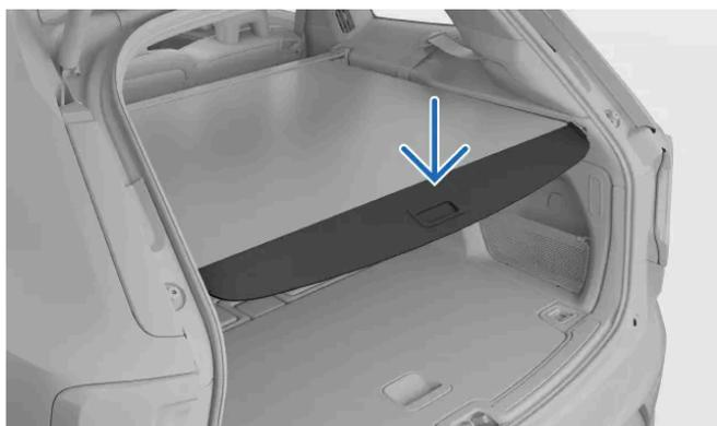
Kippen Sie die Außenkante der Laderaumabdeckung nach unten, sodass sie in den Vertiefungen einrastet.
