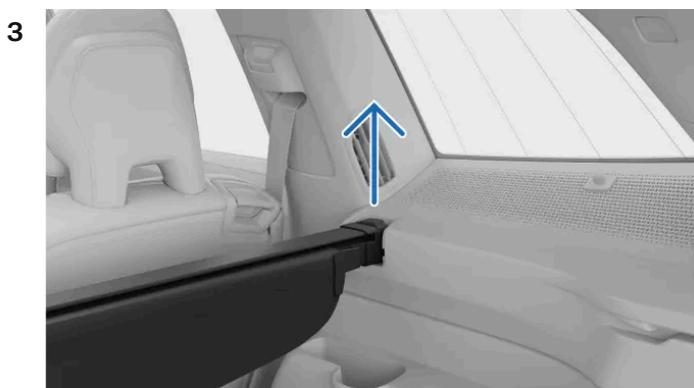
Heben Sie die Laderaumabdeckung zum Entfernen vollständig aus den Vertiefungen an der Rückseite des Kofferraums.
