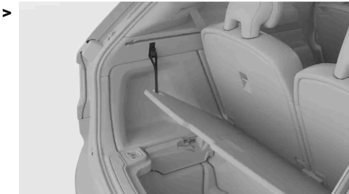
Die Klappe bleibt offen und erlaubt jetzt den Zugang zum darunter liegenden Staufach.
