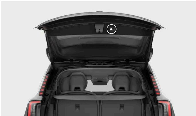
Lage der Taste zum Schließen der Heckklappe
