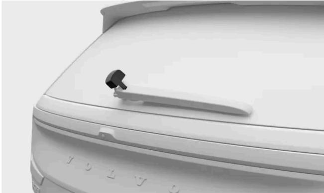
Machen Sie die Kunststoffabdeckung am Befestigungspunkt des Wischerarms am Fahrzeug ausfindig. Lösen Sie diese Abdeckung zuerst an der Seite, die Ihnen am nächsten liegt, und dann an der Seite, die am weitesten von Ihnen entfernt ist. Heben Sie die Kunststoffabdeckung ganz ab. Dadurch bekommen Sie Zugang zum Schlauchanschluss.
