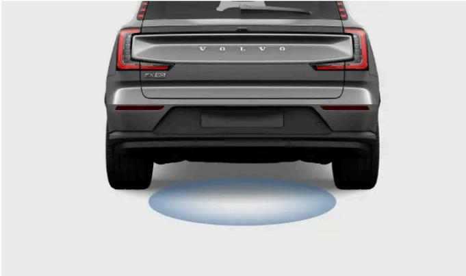
Der Sensor erfasst Bewegungen unter dem Heckstoßfänger. Dabei führt jede erfasste Bewegung zum Entriegeln der Heckklappe.
