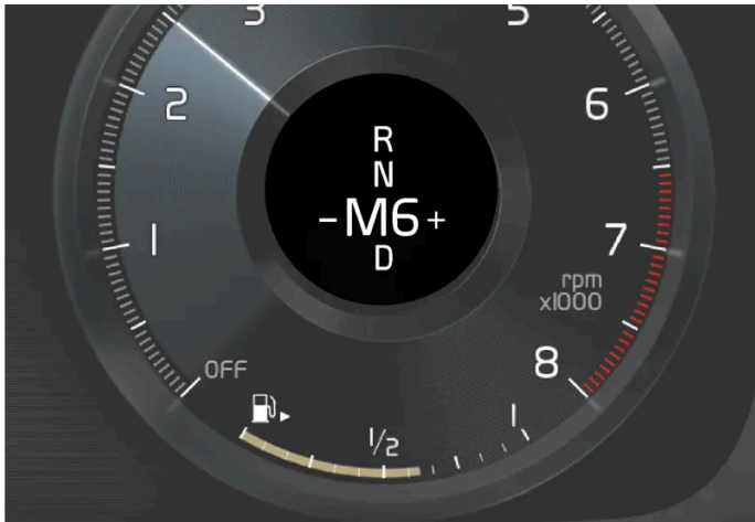
Übersicht über manuellen Schaltmodus auf dem Fahrerdisplay.
