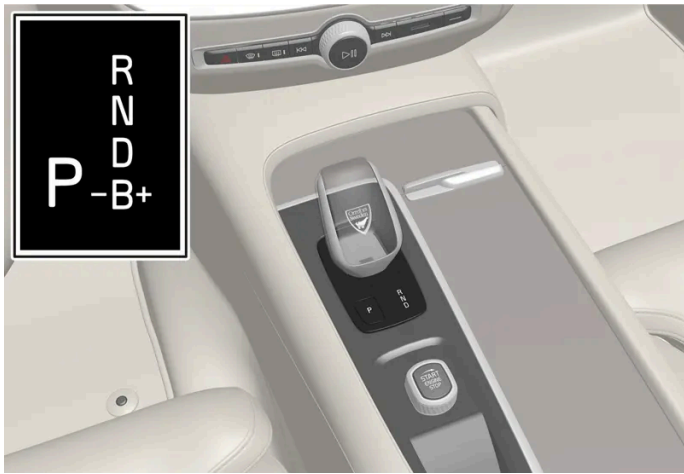
Wählhebel und Schaltmuster auf dem Fahrerdisplay.
