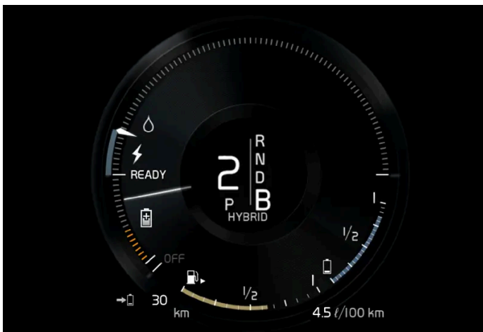
Anzeige im Fahrerdisplay bei Energierückgewinnung.
