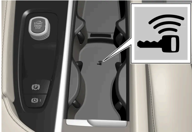
Lage des Schlüssellesegeräts an der Tunnelkonsole.
