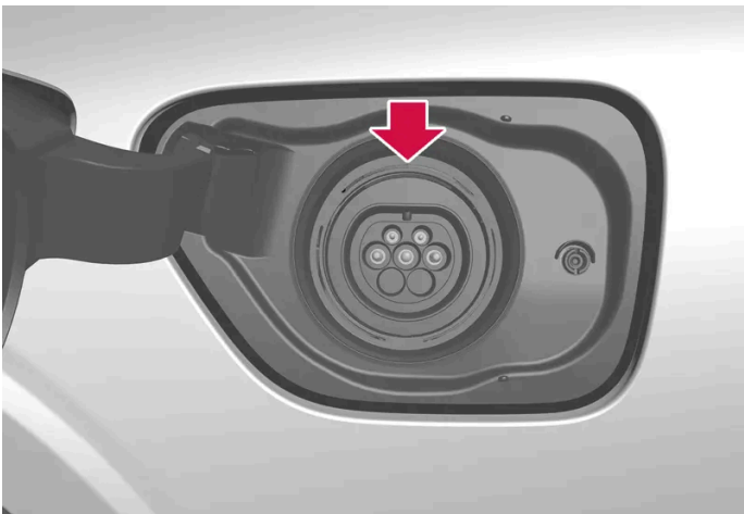
Position der LED-Leuchte am Ladeanschluss des Fahrzeugs.
