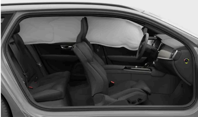
Auf einer Seite des Fahrzeugs ausgelöster Kopf-/Schulterairbag.
