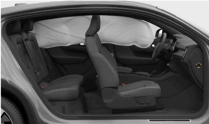
Auf einer Seite des Fahrzeugs ausgelöster Kopf-/Schulterairbag.
