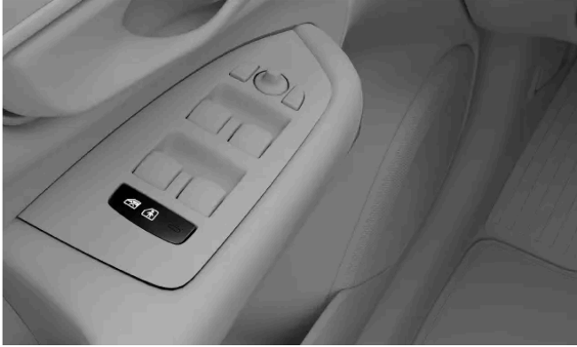
Position der Kindersicherungstaste in der Türverkleidung
