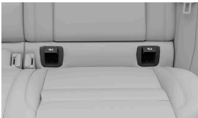
Lage der ISOFIX-Verankerungspunkte an den äußeren Rücksitzen
