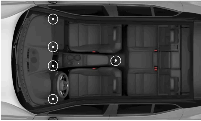
Lage der verstellbaren Lüftungsdüsen
