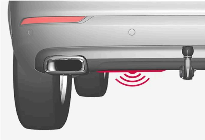
Der Sensor befindet sich etwas links von der Mitte des Stoßfängers <sup>[1]</sup>.
