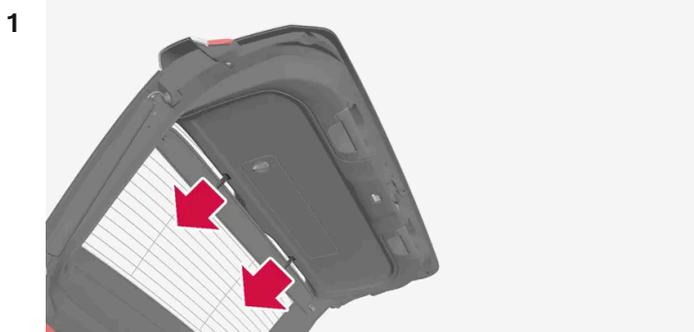
Ziehen Sie die oberen Clips der Abdeckplatte gerade aus der Heckklappe heraus.
