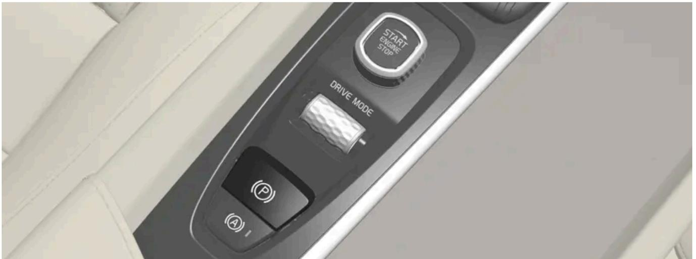
Der Hebel der Feststellbremse befindet sich auf der Tunnelkonsole zwischen den beiden Vordersitzen.
