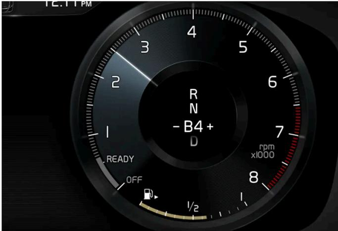
Fahrerdisplay beim Schalten mit Schaltwippen in der Schaltstellung für manuelles Schalten.
