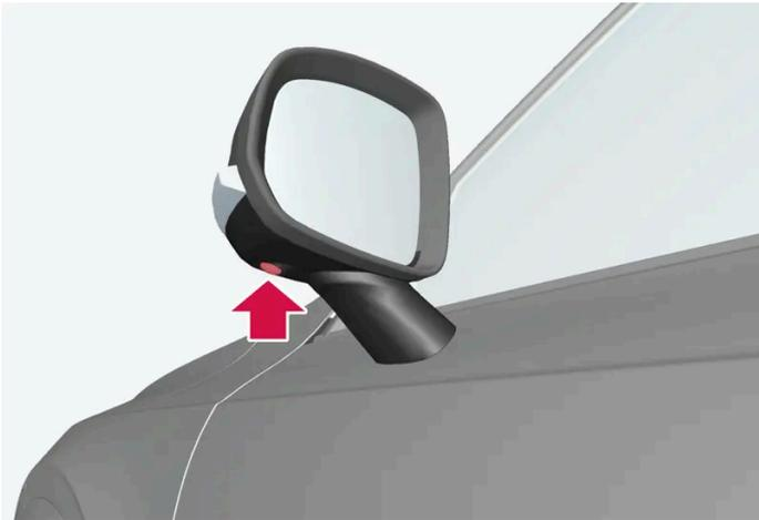
Die Seitenkameras befinden sich in den Seitenspiegeln.
