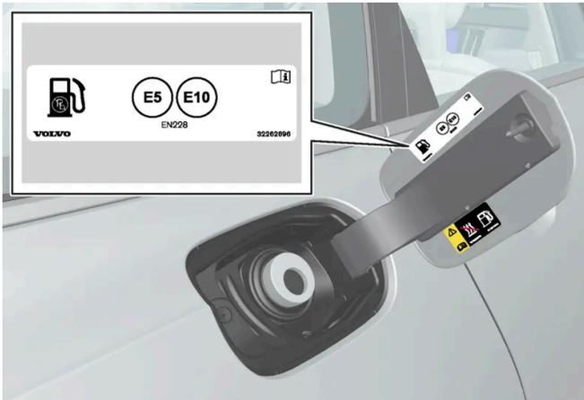
Kraftstoff tanken, der gemäß der Kennzeichnung<sup>[1]</sup> auf der Innenseite der Tankklappe für das Fahrzeug zugelassen ist. Zu zugelassenen Kraftstoffen und ihrer Kennzeichnung siehe die Abschnitte „Benzin“.
