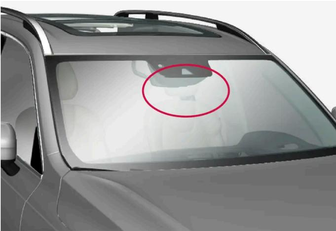
Anordnung der vorderen Kamera- und Radareinheit
