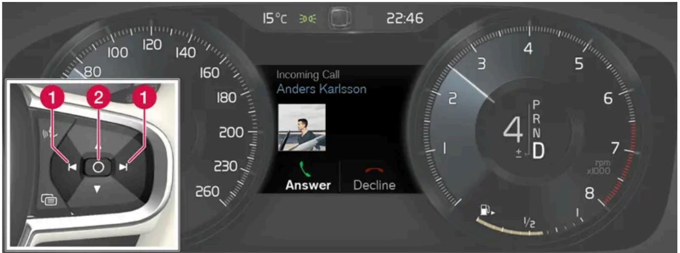
Beispiel für Meldung auf dem Fahrerdisplay und rechtem Lenkradtastenfeld. Die Abbildung ist thematisch - je nach Fahrzeugmodell können die Einzelheiten unterschiedlich sein.
