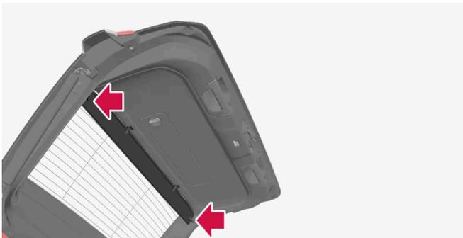
Wenden Sie die Abdeckplatte mit der Schraubenseite nach unten und manövrieren die Stifte in die Befestigung auf einer Seite der Heckklappe.
