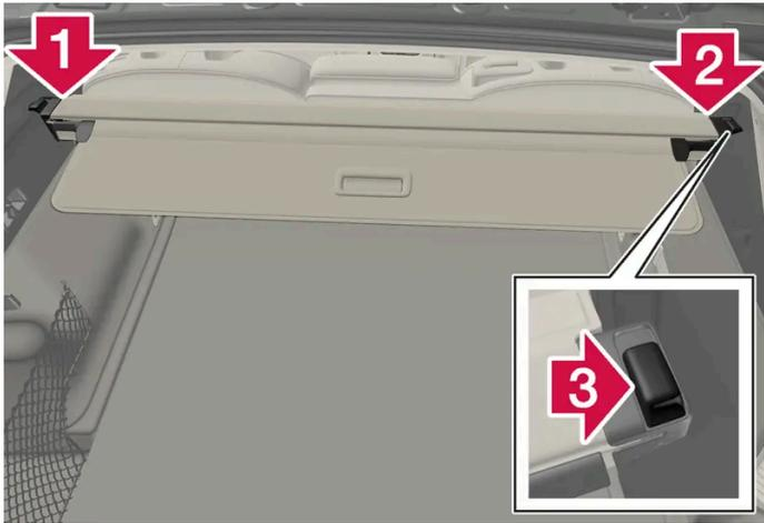
1 Zuerst eines der Endstücke der Gepäckraumabdeckung in die Aussparung in der Seitenverkleidung einschieben.
