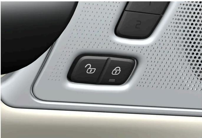
Verriegelungstasten mit Anzeigeleuchte an der Vordertür.
