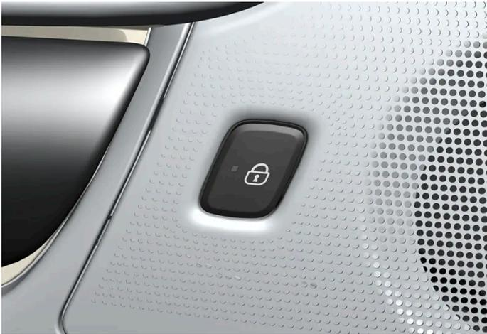
Verriegelungstaste mit Anzeigeleuchte an der Fondtür.
