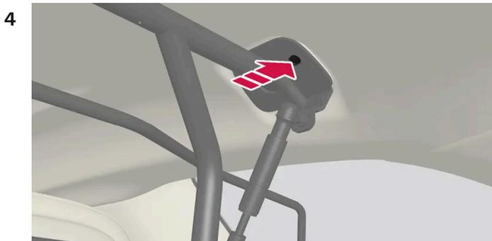
Die mitgelieferte Schraube einsetzen und anziehen. Ein 6-mm-Inbusschlüssel ist im Lieferumfang enthalten. Auf der anderen Seite ebenso vorgehen. Empfohlenes Anzugsmoment: 20 Nm (15 ft-lb).
