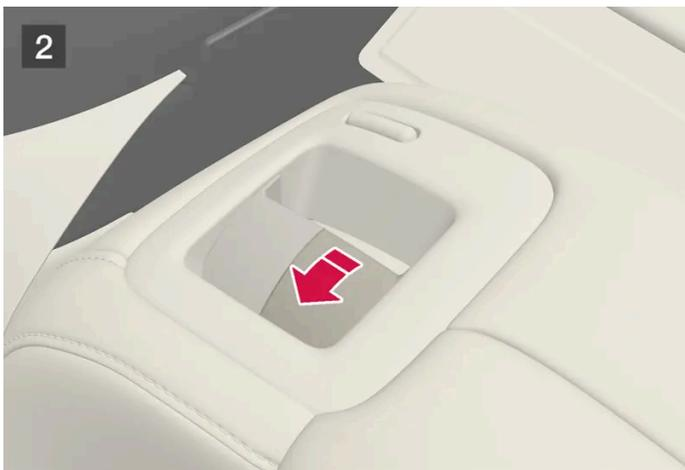
Bei Fahrzeugen ohne elektrische Umklappfunktion werden die Kopfstützen der äußeren Sitze mit dem innenliegenden Hebel oben am Sitz von Hand umgeklappt, siehe Abbildung **2**.
