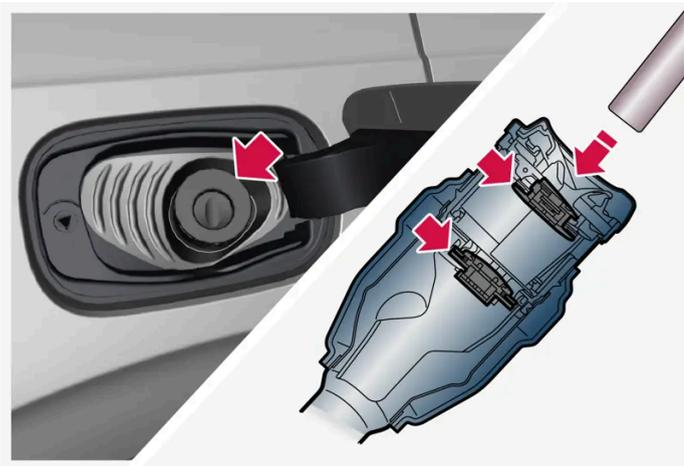
Es ist wichtig, das Trichterrohr der Zapfpistole an den beiden zu öffnenden Klappen des Einfüllrohrs passieren zu lassen, bevor man mit dem Tanken beginnt.
