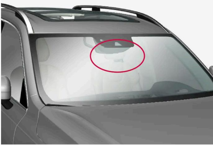
Anordnung der vorderen Kamera- und Radareinheit
