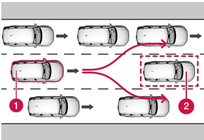
Das eigene Fahrzeug (1) „erkennt“ keine Möglichkeit, dem vorausfahrenden Fahrzeug (2) auszuweichen und wird daher ggf. schon früher automatisch abgebremst.
