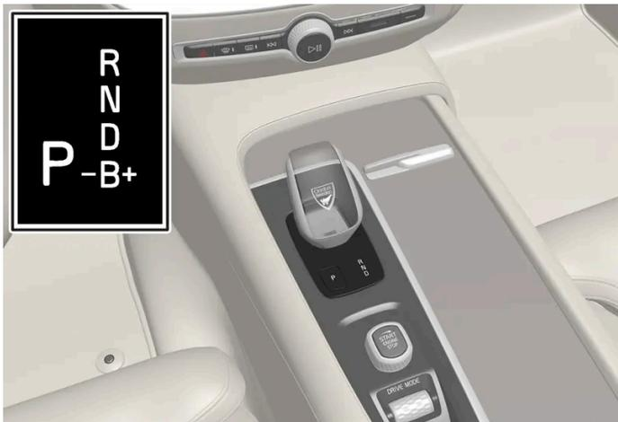
Wählhebel und Schaltmuster auf dem Fahrerdisplay.
