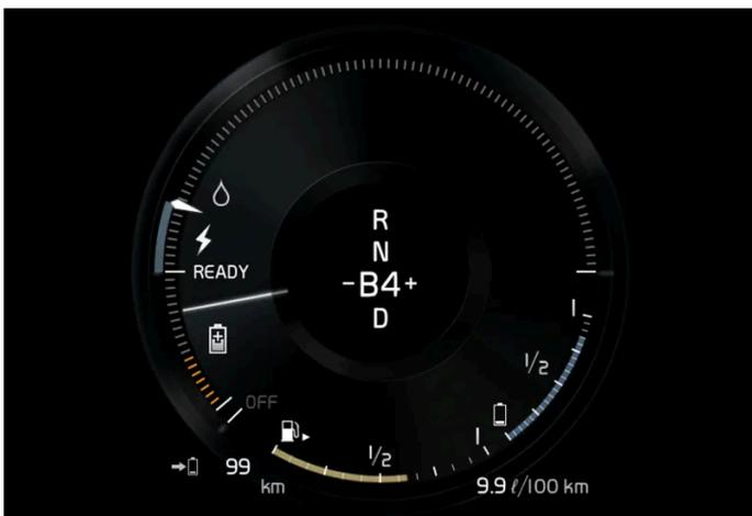
Das Fahrzeug produziert Strom für die Batterie, die Batterie wird geladen, z. B. bei einem leichten Druck auf das Bremspedal oder beim Motorbremsen bei der Bergabfahrt.
