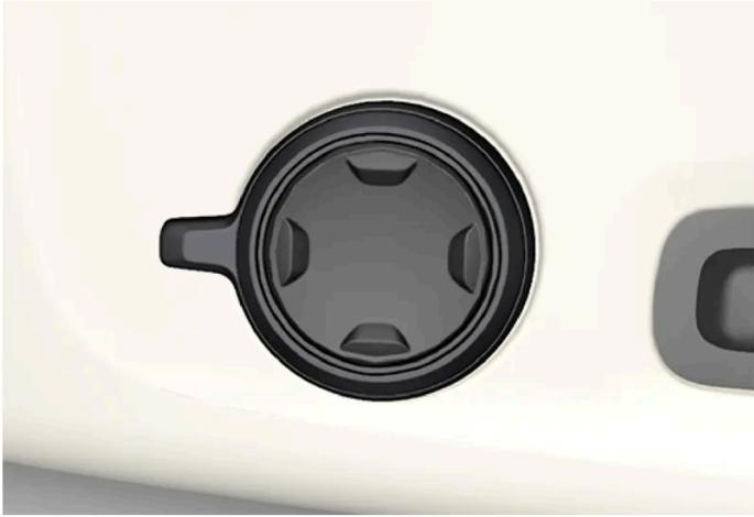
Multifunktionsschalter, in Fahrzeugen mit Vier-Wege-Lendenwirbelstütze\*.
