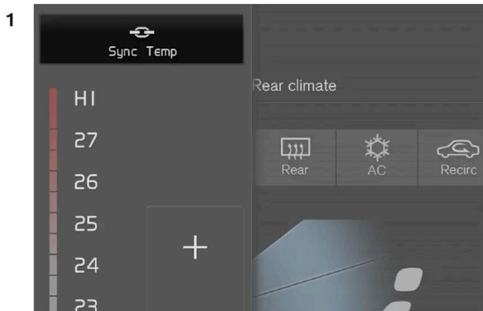
Synchronisierungstaste für den Temperaturregler der Fahrerseite.
