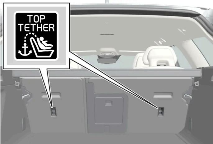
Sie erkennen die Befestigungspunkte für den Rücksitz an den Symbolen an der Rückseite der Rückenlehne.
