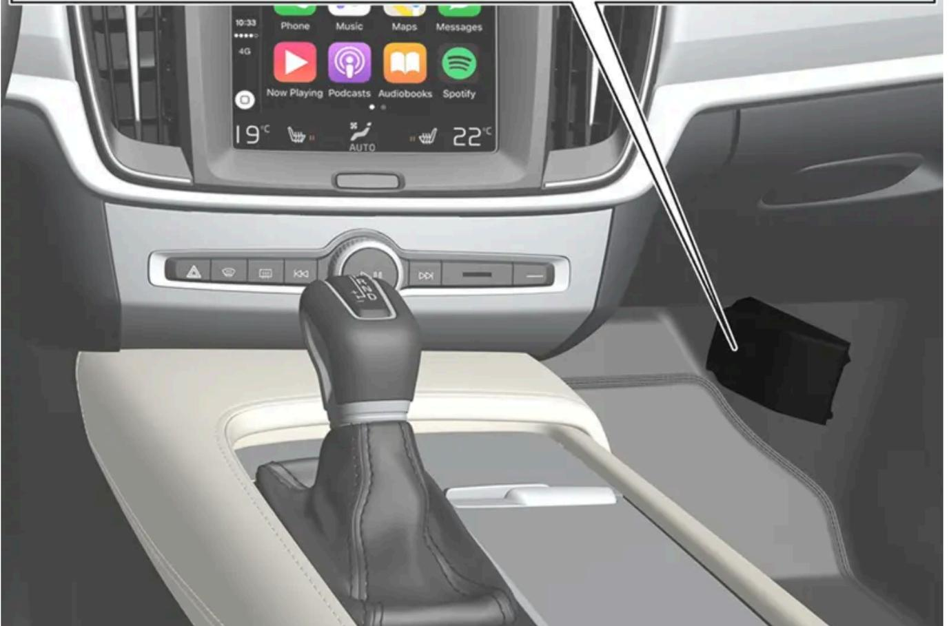
Der Sicherungskasten befindet sich hinter der Bodenmatte/Seitenverkleidung.
