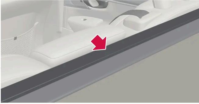
Vor dem Einsetzen der Kassette kontrollieren, dass die vordere Abdeckklappe hinter den Rückenlehnen nach unten weist.
