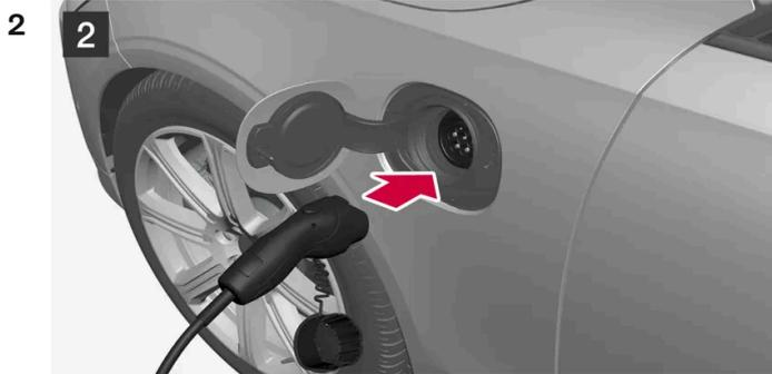
2 Die Ladeklappe öffnen. Schutzverschluss des Ladestutzens abziehen und dann den Stutzen ganz in den Anschluss des Fahrzeugs einführen.
