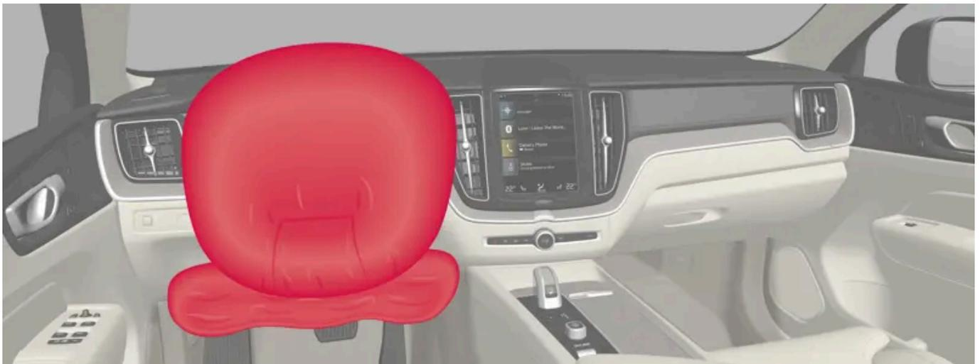
Lenkrad-Airbag und Knie-Airbag<sup>[1]</sup> am Fahrersitz.
