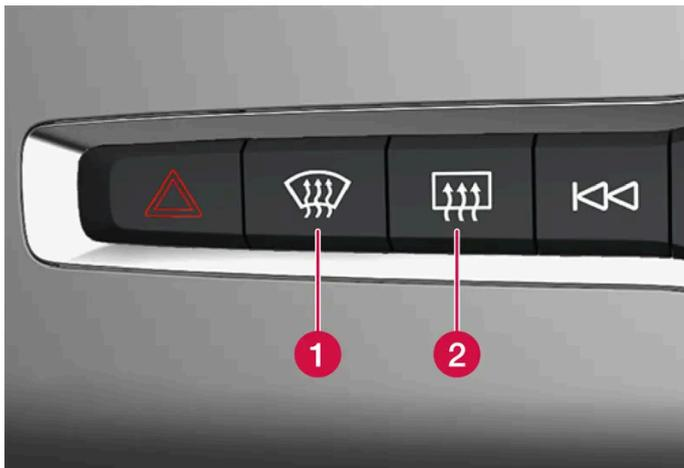
1 Taste für die Windschutzscheibenheizung\* und maximale Entfrostung.
