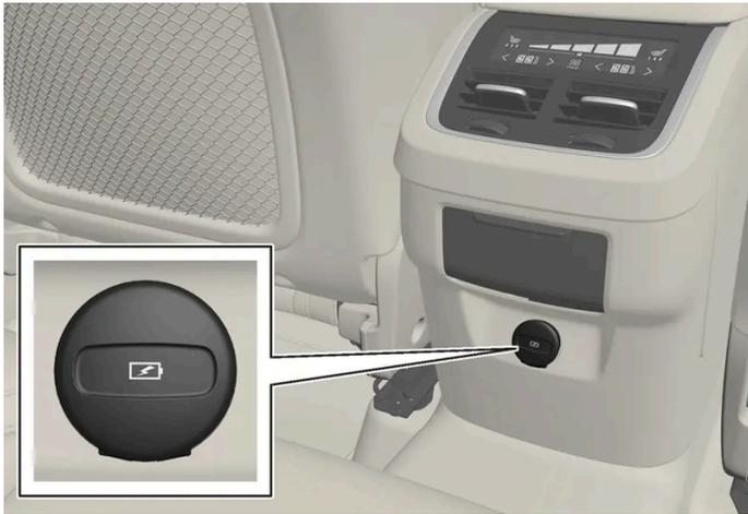
USB-Buchsen (Typ C) hinten an der Tunnelkonsole, z. B. zum Aufladen von Telefonen und Tablets<sup>[1]</sup>.
