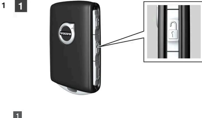
Fahrzeug mit dem Transponderschlüssel entriegeln – die Aufladung wird beendet und der Ladestutzen wird entriegelt.
