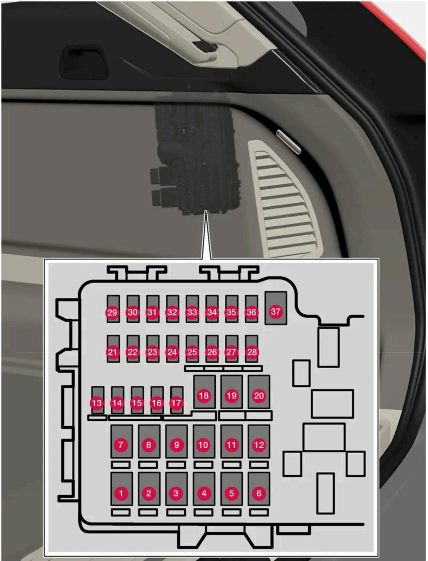
Der Sicherungskasten befindet sich rechts hinter der Verkleidung.
