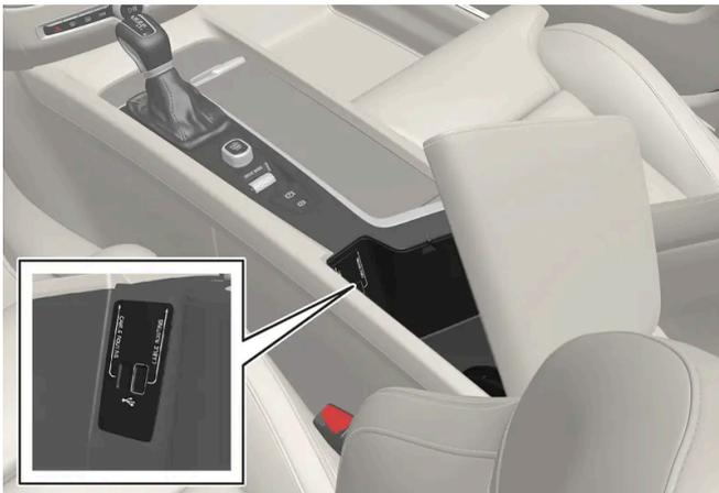
Je nach Fahrzeugmodell kann die Position des Anschlusses variieren.
