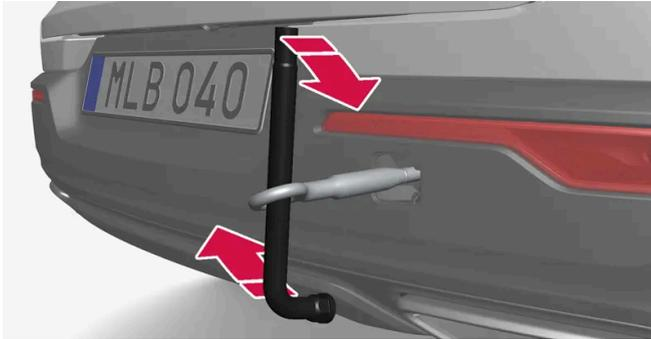
Öse ordentlich festziehen, dafür als Hebel zum Beispiel den Radmutterenschlüssel\* verwenden.
