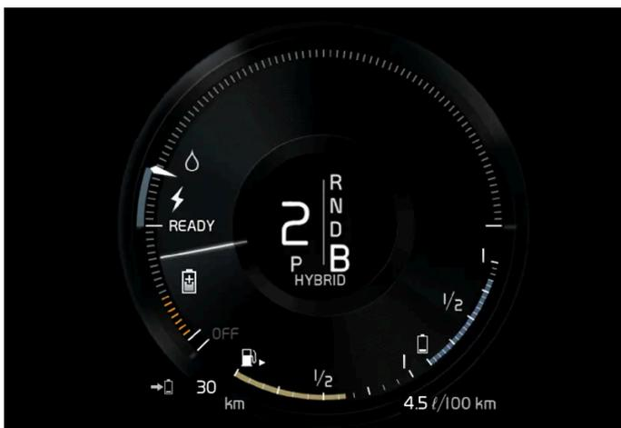
Anzeige im Fahrerdisplay bei Energierückgewinnung.
