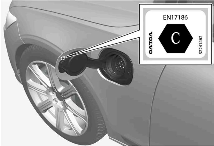
Ladestrom wählen, der gemäß der Kennzeichnung <sup>[1]</sup> auf der Innenseite des Ladeanschlusses für das Fahrzeug zugelassen ist.
