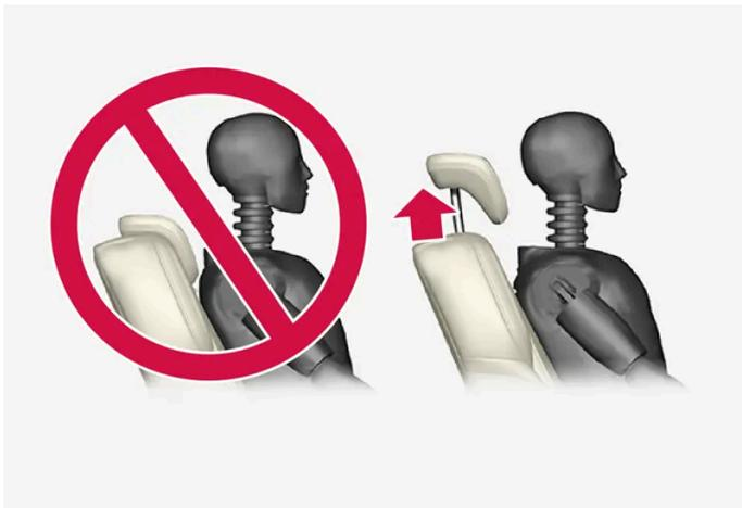
Passen Sie die Kopfstütze des mittleren Rücksitzes so an die Körpergröße an, dass nach Möglichkeit der ganze Hinterkopf aufliegt. Die Kopfstütze manuell in die gewünschte Höhe schieben.
