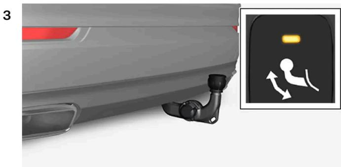
Führen Sie die Anhängerkupplung in ihre Endstellung und lassen Sie sie einrasten – die Anzeigeleuchte leuchtet konstant orange.
