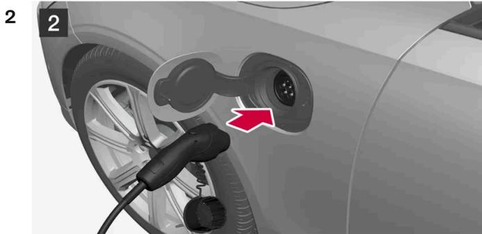
2 Die Ladeklappe öffnen. Schutzverschluss des Ladestutzens abziehen und dann den Stutzen ganz in den Anschluss des Fahrzeugs einführen.
