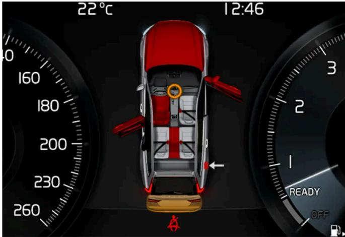
Grafik im Fahrerdisplay mit verschiedenen Arten von Warnungen. Die Warnfarbe an Türe und Heckklappe ist von der Geschwindigkeit des Fahrzeugs abhängig.
