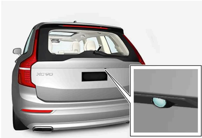
Die nach hinten gerichtete Kamera befindet sich über dem Nummernschild.
