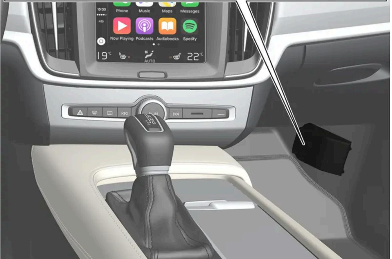
Der Sicherungskasten befindet sich hinter der Bodenmatte/Seitenverkleidung.
