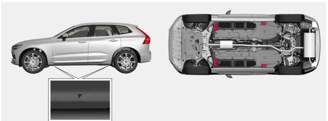
Die Dreiecke an der Kunststoffverkleidung zeigen, wo sich die Wagenheber-Befestigungspunkte/Aufnahmepunkte (rot markiert) befinden.
