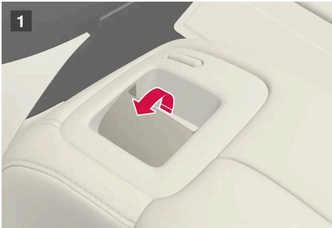
Bei Fahrzeugen mit elektrisch betätigtem \* Umklappen der Kopfstützen im Fond können die Kopfstützen der äußeren Sitze mithilfe der Handgriffe an der Oberseite der Sitze umgeklappt werden, siehe Abbildung **1**. Beachten Sie, dass hierdurch auch die Rückenlehnen umgeklappt werden. Wenn nur eine Kopfstütze umgeklappt werden soll, zum Beispiel um die Sicht zu verbessern, dann verwenden Sie dazu stattdessen das Center Display\*.
