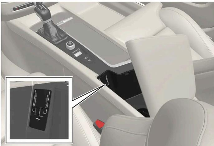
USB-Buchsen (Typ A) an der Tunnelkonsole. Richten Sie das Kabel nach vorn aus, damit es beim Schließen des Deckels nicht eingeklemmt wird.
