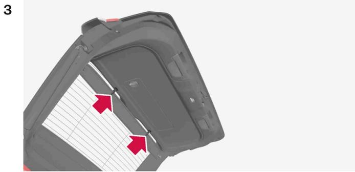
Die beiden oberen Clips in die jeweilige Montagebuchse der Heckklappe drücken, so dass diese einklicken.
