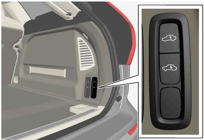
Schalter zum Anheben und Absenken der Heckpartie des Fahrzeugs.
