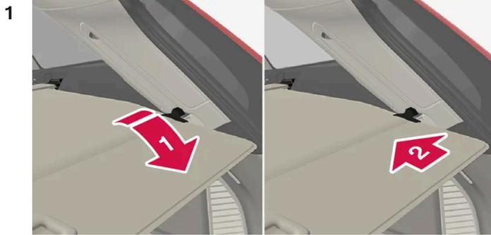
**1** → Den Griff fassen und die Abdeckung vollständig herausziehen.
