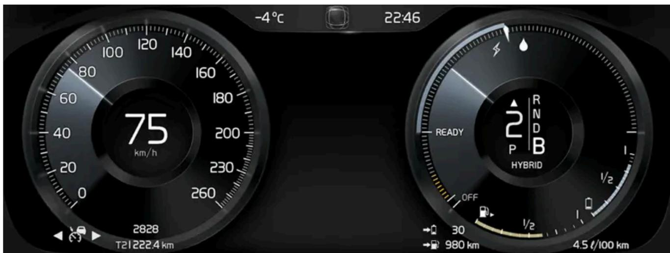
Auf dem Fahrerdisplay werden z. B. Informationen zur Geschwindigkeit, zu eingehenden Anrufen oder zum abgespielten Musiktitel angezeigt. Es wird mit den beiden Tastenfeldern auf dem Lenkrad bedient.
