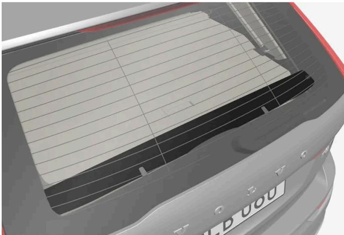
Bei Verwendung der Gepäckraumabdeckung muss an der Heckklappe eine Abdeckplatte montiert werden.
