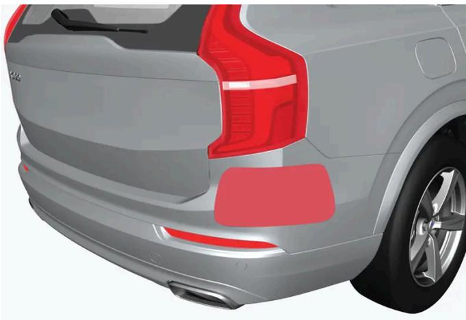
Platzierung der hinteren Radareinheiten
