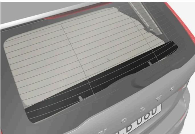
Die innen an der Heckscheibe angebrachte hintere Abdeckklappe ergänzt die Gepäckraumabdeckung.
