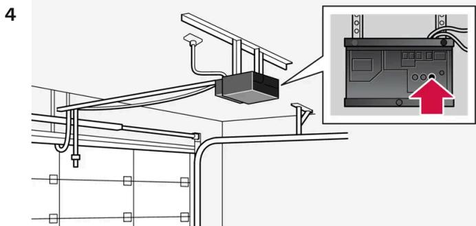
Finden Sie die Anlerntaste<sup>[2]</sup> am Empfänger, z. B. Garagentor. Die Platzierung ist normalerweise in der Nähe der Antennenfassung am Empfänger.
