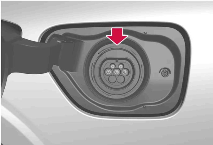
Position der LED-Leuchte am Ladeanschluss des Fahrzeugs.
