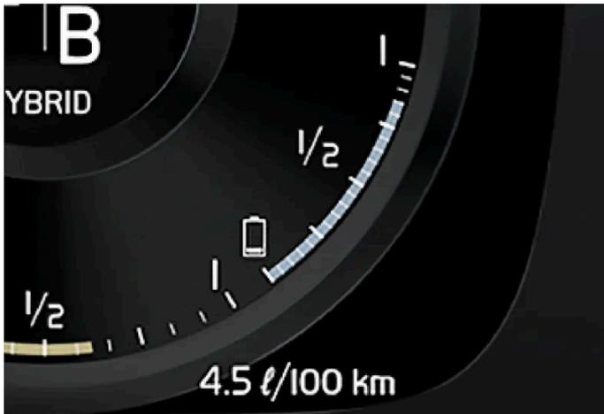
Die in der Hybridbatterie gespeicherte Energie wird vom Elektromotor, aber auch zum Kühlen oder Beheizen des Fahrzeugs genutzt. Der Bordcomputer berechnet, welche Strecke mit der in der Hybridbatterie gespeicherten Batterie ungefähr noch zurückgelegt werden kann.
