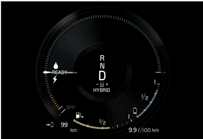
Das Fahrzeug wurde angelassen, steht aber; es wird keine Leistung angefordert.
