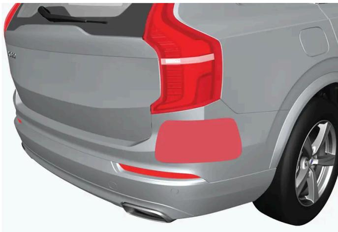
Platzierung der hinteren Radareinheiten
