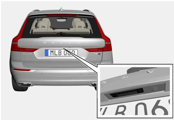
Die Heckklappe wird von einem elektrischen Schloss geschlossen gehalten.
