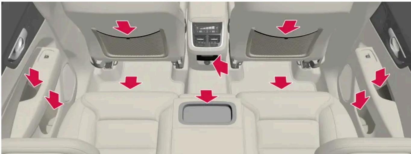
Ablagefächer in der Türverkleidung, Getränkehalter\* an der Rückenlehne des mittleren Sitzplatzes, Einsteckfach an den Rückenlehnen der Vordersitze, USB-Buchsen an der Tunnelkonsole sowie Ablagefach unter dem Sitz.
