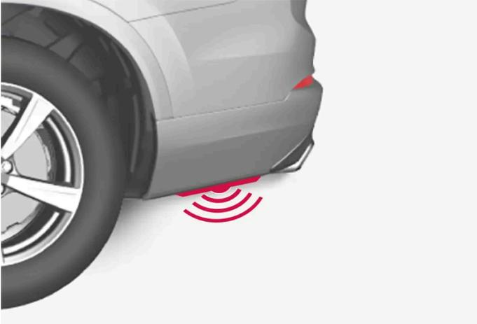
Um das Öffnen oder Schließen mithilfe einer Fußbewegung an Fahrzeugen zu aktivieren, die mit einer Schutzplatte ausgerüstet sind, erfolgt die Bewegung von der Seite des Fahrzeugs aus. Einer der Transponderschlüssel des Fahrzeugs muss sich in Reichweite (ca. 1 Meter (3 Fuß)) befinden, damit das Öffnen und Schließen möglich ist.
