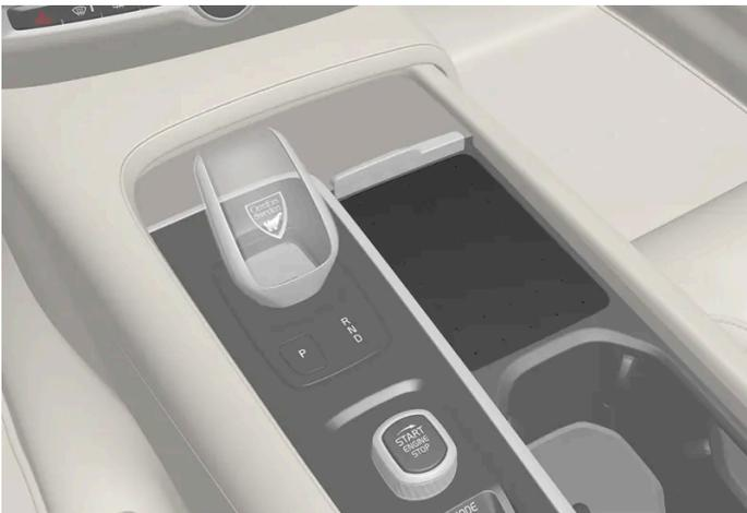
Drahtlos-Telefonladegerät an der Tunnelkonsole.
