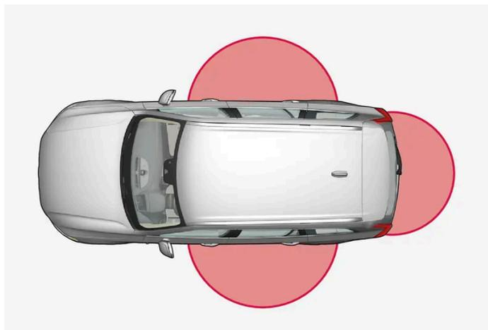
Der markierte Bereich auf dem Bild zeigt die Reichweite der Antennen des Systems.
