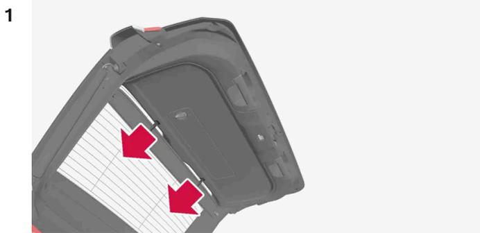
Ziehen Sie die oberen Clips der Abdeckplatte gerade aus der Heckklappe heraus.
