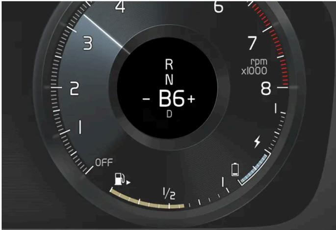
Übersicht über Bremsstellung auf dem Fahrerdisplay.
