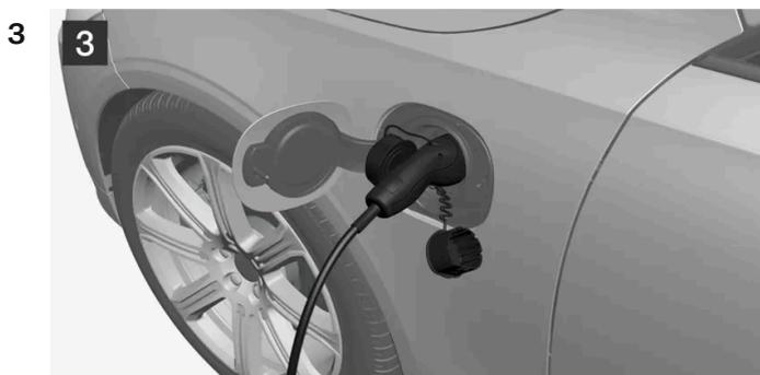
3 Positionieren Sie den Schutzdeckel des Ladestutzens so, dass er nicht am Fahrzeug anstößt.
