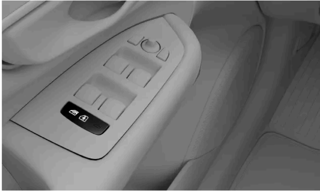
Position der Kindersicherungstaste in der Türverkleidung
