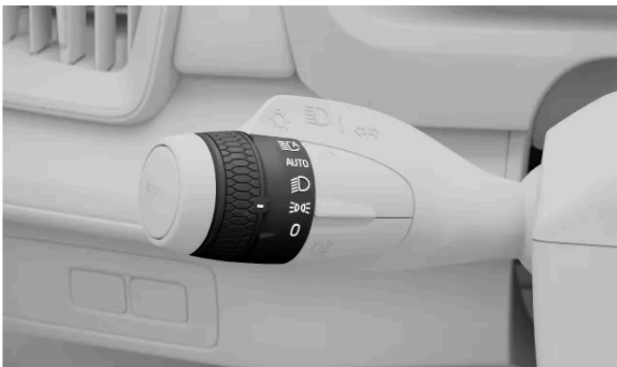
Symbol der Positionsleuchten am Drehring des linken Lenkradhebels
