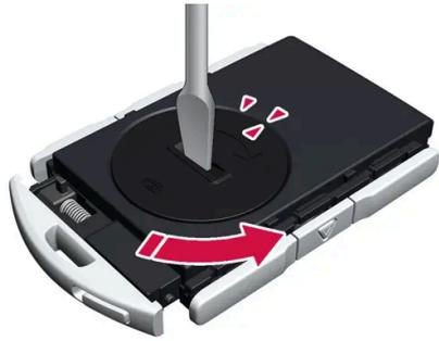
Drehen Sie den Deckel des Batteriefachs gegen den Uhrzeigersinn in Stellung OPEN. Nehmen Sie z. B. einen Schraubendreher oder eine Münze zu Hilfe.
