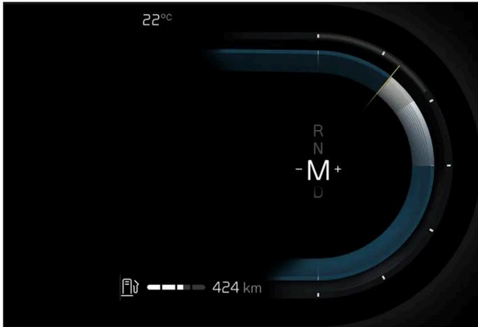
In Schaltstellung M ist ein manuelles Schalten möglich. Der Motor bremst, wenn das Gaspedal losgelassen wird.
