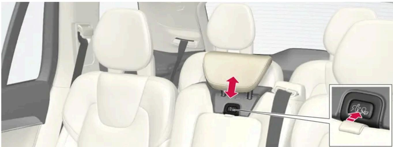
Zum Absenken der Kopfstütze die Taste (in der Mitte zwischen Rückenlehne und Kopfstütze, siehe Abbildung) drücken und die Kopfstütze gleichzeitig vorsichtig hinunterdrücken.
