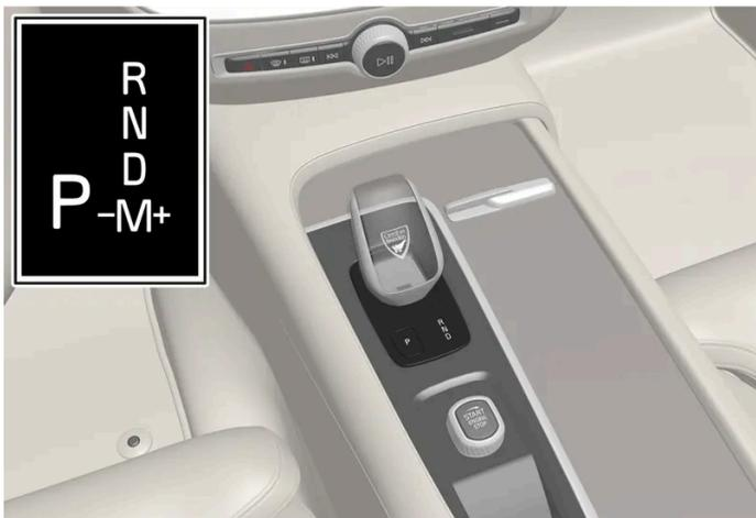
Wählhebel und Schaltmuster auf dem Fahrerdisplay.
