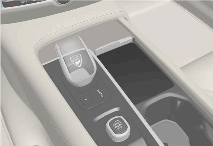
Kabellose Ladeablage an der Tunnelkonsole.
