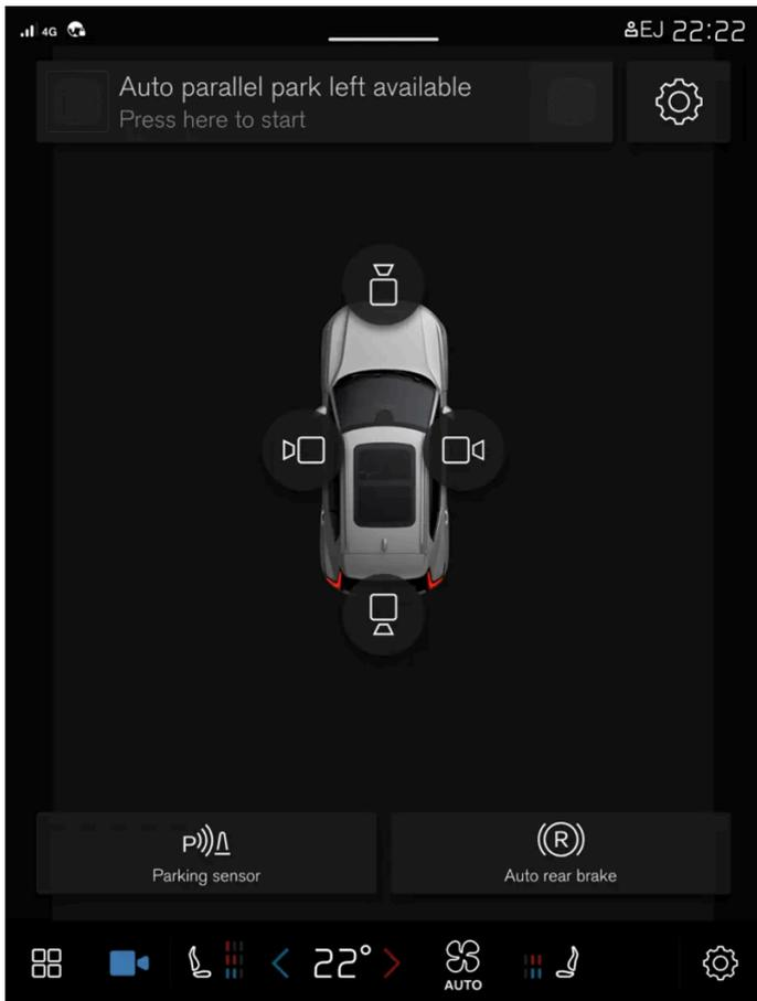
Die Kamera-Ansicht zeigt die Einparkhilfekameras (PAC<sup>[1]</sup>), die eine zusammengesetzte 360°-Rundumsicht sowie eine separate Ansicht für jede der vier Kameras anzeigen können: Heckansicht, Frontansicht, Ansicht linke Seite, Ansicht rechte Seite.
