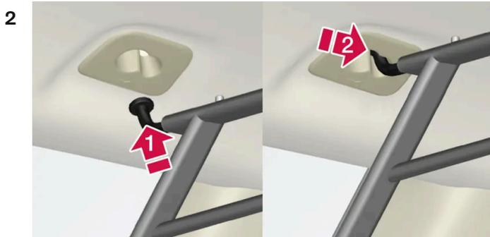
Führen Sie einen Haken des Gitters in die größere Öffnung der Montagevorrichtung an der Decke ein (1).
