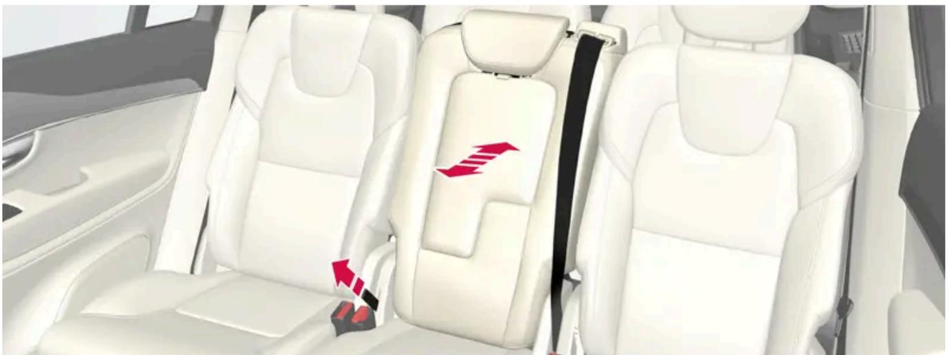
1 Ziehen Sie am Riemen, der sich rechts am mittleren Sitz befindet.
