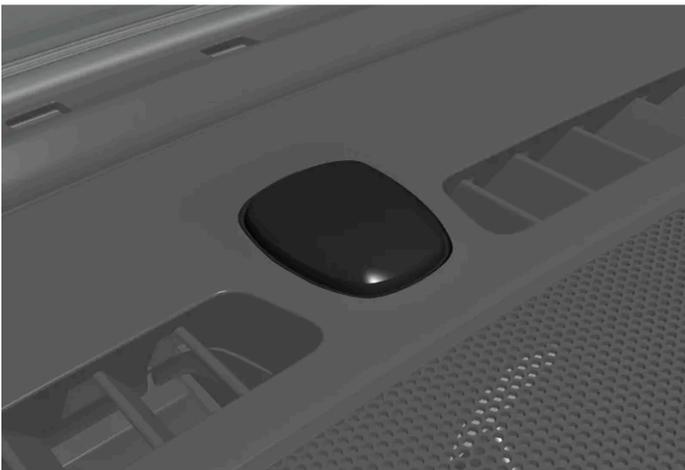
Die Verriegelungs- und Alarmanzeige befindet sich in der Mitte der Instrumententafel, nahe der Windschutzscheibe.
