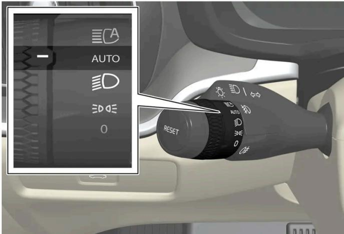
Drehring am Lenkradhebel in Stellung **AUTO**.
