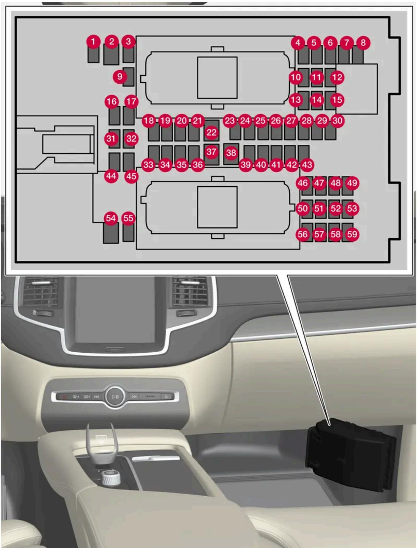
Der Sicherungskasten befindet sich hinter der Bodenmatte/Seitenverkleidung.
