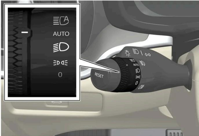
Drehring am linken Lenkradhebel.
