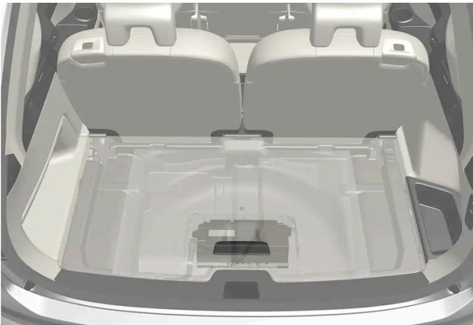
Mild-Hybrid-Fahrzeuge haben eine 48-V-Hilfsbatterie unter dem Laderaum. Arbeiten an Batterie und Batteriekasten dürfen nur von einer Vertragswerkstätte durchgeführt werden.
