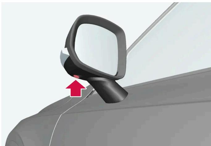
Die Seitenkameras befinden sich in den Seitenspiegeln.
