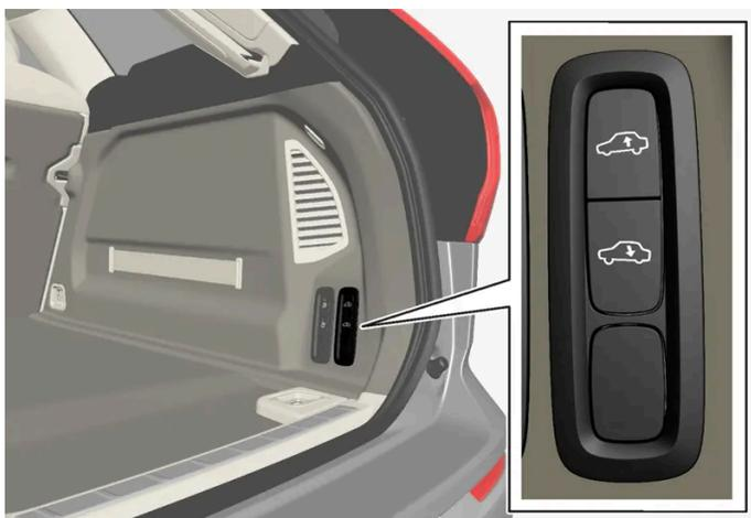
Mit den Tasten im Kofferraum können Sie die Höhe des Hecks einstellen, um das Beladen oder das An- oder Abkuppeln eines Anhängers zu erleichtern.
