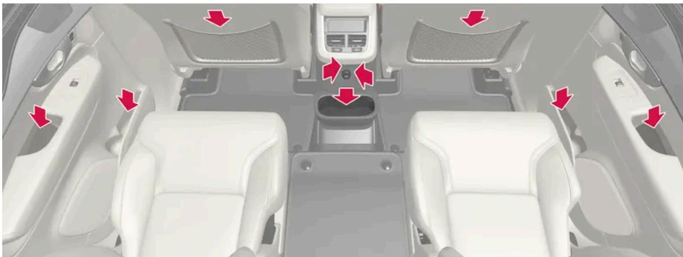
Ablagefächer in der Türverkleidung, Getränkehalter in der Tunnelkonsole, Einsteckfach\* an den Rückenlehnen der Vordersitze und USB-Buchsen an der Tunnelkonsole.
