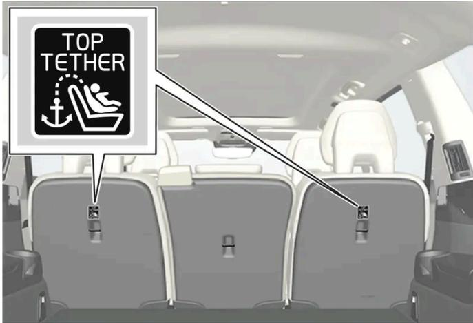
Ausführung mit fünf oder sieben Sitzen: Sie erkennen die Befestigungspunkte für die zweite Sitzreihe an den Symbolen an der Rückseite der Rückenlehne.
