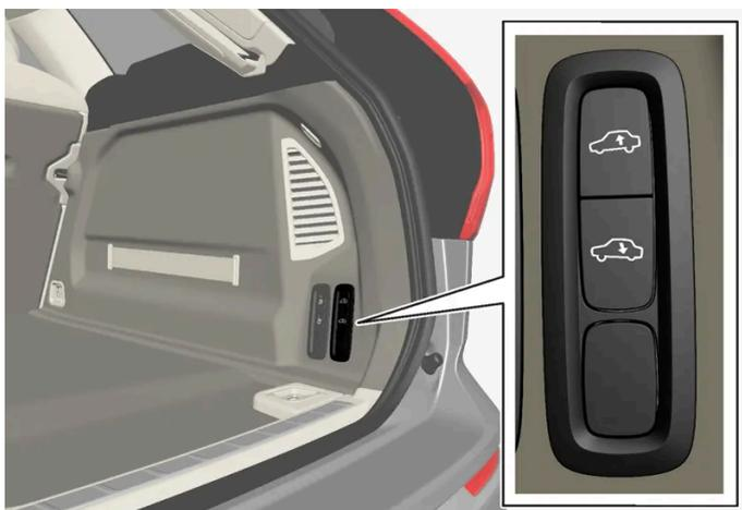
Mit den Tasten im Kofferraum können Sie die Höhe des Hecks einstellen, um das Beladen oder das An- oder Abkuppeln eines Anhängers zu erleichtern.
