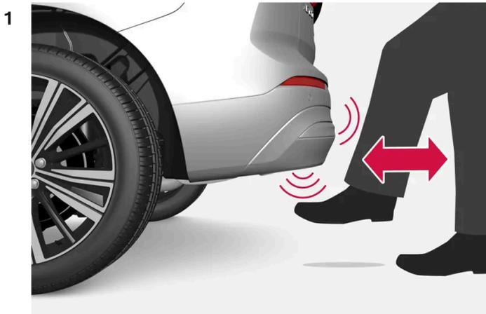
Führen Sie im Sensorbereich unter dem Heckstoßfänger **eine** nach vorn gerichtete Fußbewegung aus. Danach einen Schritt zurücktreten. Berühren Sie den Stoßfänger nicht.
