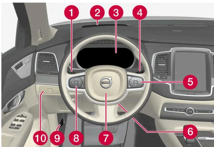
**1** Positionsleuchten, Tagfahrlicht, Abblendlicht, Fernlicht, Blinker, Nebelscheinwerfer/Kurvenlicht\*, Nebelschlussleuchte, Zurücksetzen des Tageskilometerzählers
