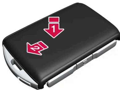
Bringen Sie die untere Abdeckung in der umgekehrten Reihenfolge wieder an. Die untere Abdeckung ist nicht mit einem Logo versehen. Drücken Sie die Abdeckung herunter, bis ein Klicken zu hören ist, und schieben Sie sie anschließend die letzten Millimeter in die ursprüngliche Position zurück.
