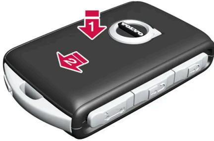
Bringen Sie vordere Abdeckung in der umgekehrten Reihenfolge wieder an. Drücken Sie die Abdeckung herunter, bis ein Klicken zu hören ist, und schieben Sie sie anschließend die letzten Millimeter in die ursprüngliche Position zurück.
