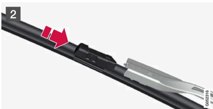
Kontrollieren Sie, dass sich die Scheibenwischer in der Wartungsstellung befinden, und stellen Sie die Wischerarme auf. Die Wartungsstellung wird bei stehendem Fahrzeug und ausgeschalteten Scheibenwischern über das Center Display aktiviert und deaktiviert.
