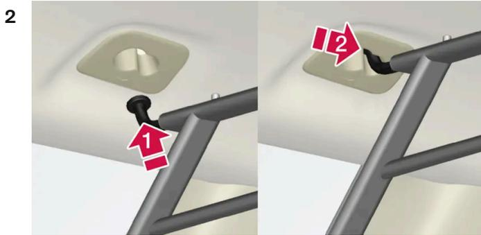
Führen Sie einen Haken des Gitters in die größere Öffnung der Montagevorrichtung an der Decke ein (1).
