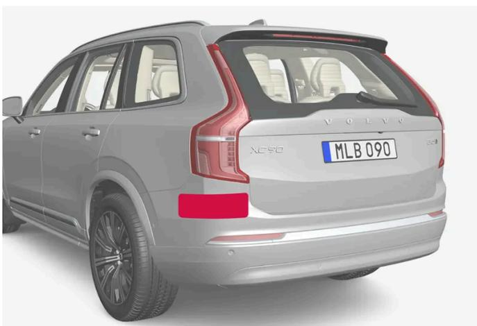
Platzierung der hinteren Radareinheiten
