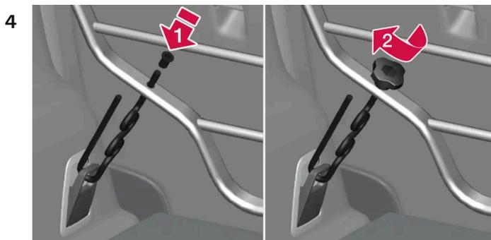
Führen Sie den Haken des Montagebügels von unten durch die Verzurröse am Kofferraumboden und das Gewinde von unten durch die untere Montagebohrung des Gitters (1).
