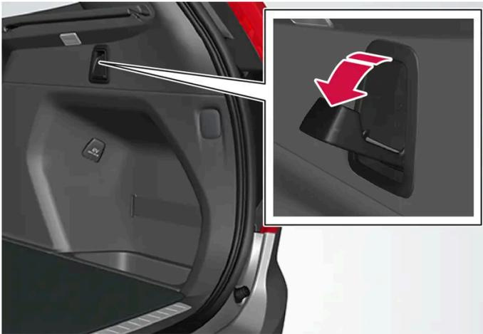
In der rechten und linken Seitenverkleidung des Kofferraums befinden sich zwei ausklappbare Taschenhaken.
