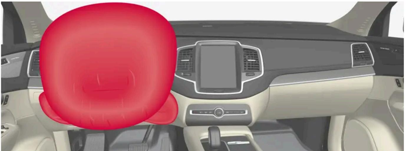
Lenkrad-Airbag und Knie-Airbag am Fahrersitz.
