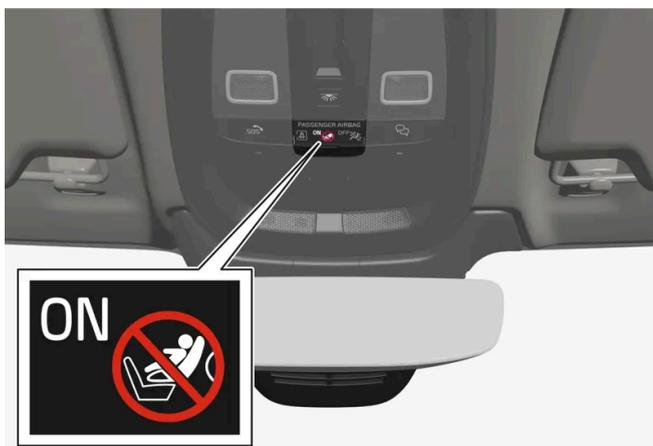
➤ Eine Textmeldung und ein Warnsymbol in der Deckenkonsolle zeigen an, dass der Beifahrerairbag aktiviert ist.
