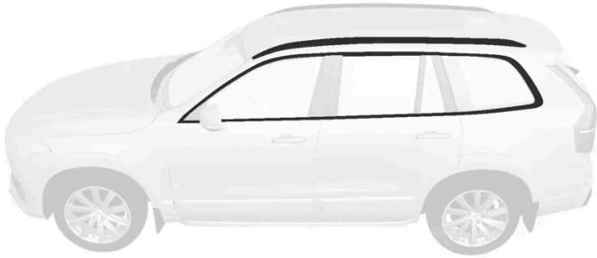
Teile, die mit Reinigungsmitteln mit einem pH-Wert zwischen 3,5 und 11,5 gereinigt werden sollten.
