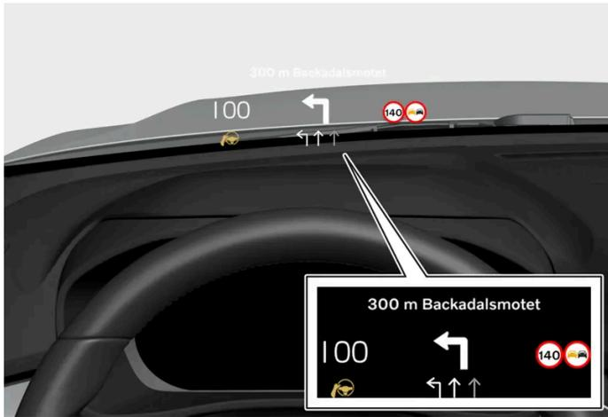
Das Head-up-Display projiziert Inhalte des Fahrerdisplays so auf die Windschutzscheibe, dass diese direkt im Blickfeld der Person hinter dem Steuer liegen. Die Informationen sind nur vom Fahrersitz aus sichtbar.
