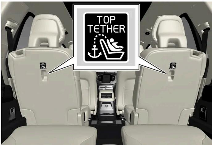
Ausführung mit sechs Sitzen: Sie erkennen die Befestigungspunkte für die zweite Sitzreihe an den Symbolen an der Rückseite der Rückenlehne.
