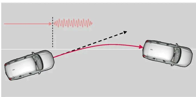
Der Spurassistent warnt den Fahrer mit Lenkradvibrationen.
