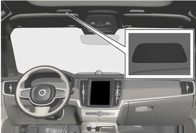
Mikrofon des Sprachsteuerungssystems
