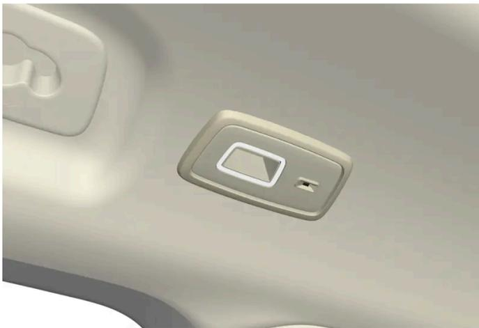
In Fahrzeugen mit Panoramadach\* befinden sich die beiden Leuchteinheiten jeweils an der Seite des Daches. <sup>[2]</sup>
