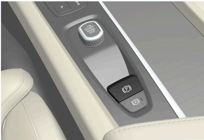
Der Hebel der Feststellbremse befindet sich auf der Tunnelkonsole zwischen den beiden Vordersitzen.
