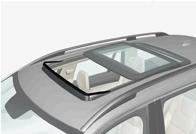
Zum Panoramadach gehört ein Windabweiser, der bei geöffnetem Panoramadach hochgeklappt wird.
