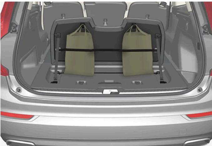
Im Deckel der Bodenklappe befinden sich zwei Taschenhaken und ein elastisches Spannband <sup>[2]</sup>. Das Band lässt sich in vier Lagen befestigen.
