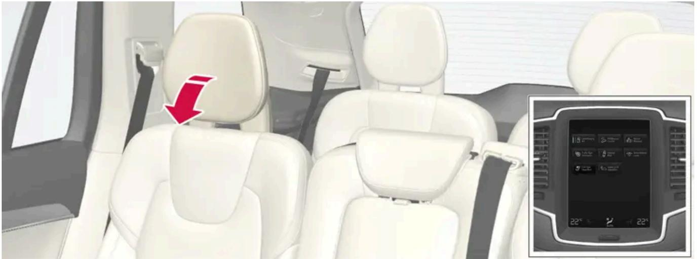
Die äußeren Kopfstützen können in der Funktionsansicht des Center Displays umgelegt werden. Die Kopfstütze lässt sich in Zündstellung 0 umklappen.
