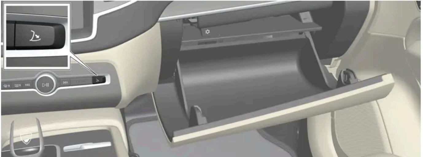
Das Handschuhfach wird durch einen Druck auf die Öffnungstaste auf der Mittelkonsole geöffnet.
