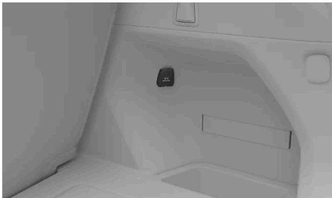
Die 12-V-Steckdose an der rechten Kofferraumwand
