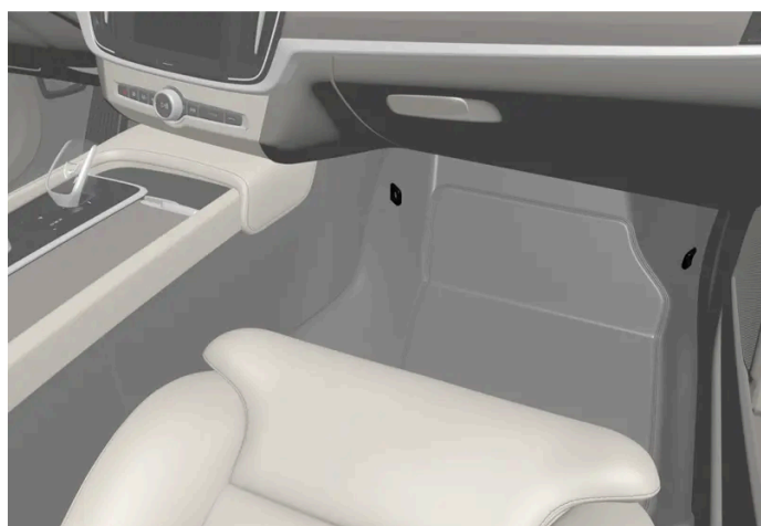
Befæstelsespunkternes placering på forsædet.
