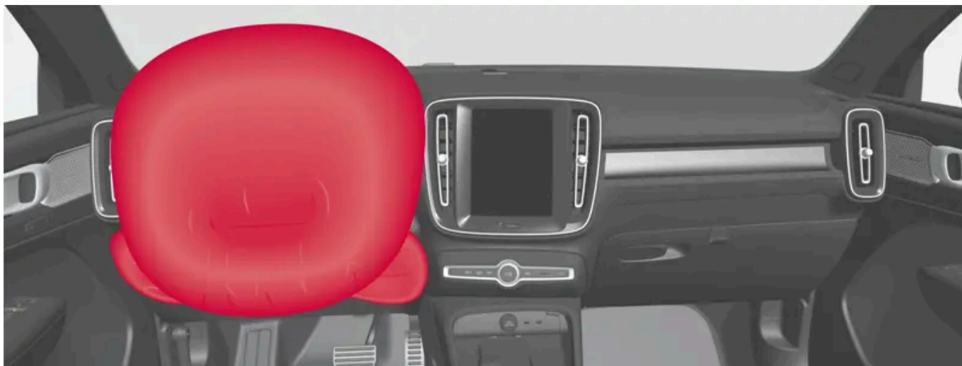
Rat-airbag og knæ-airbag [1] til forsædet i førersiden.
