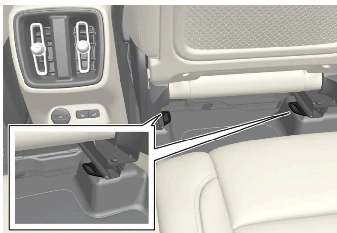
Befæstelsespunkternes placering på bagsædet.
