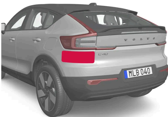
Placering af bageste radarenheder
