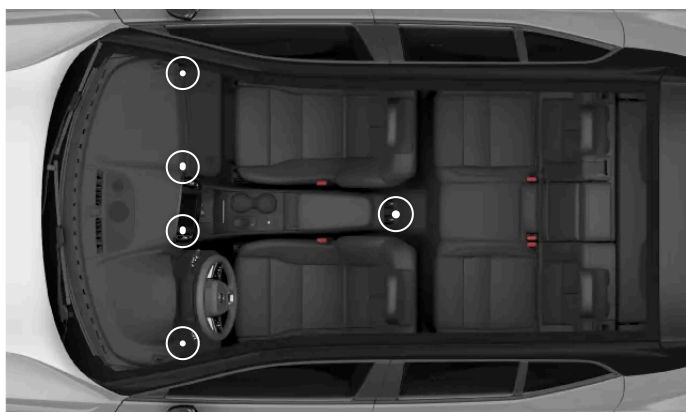
De justerbare luftdysers placering
