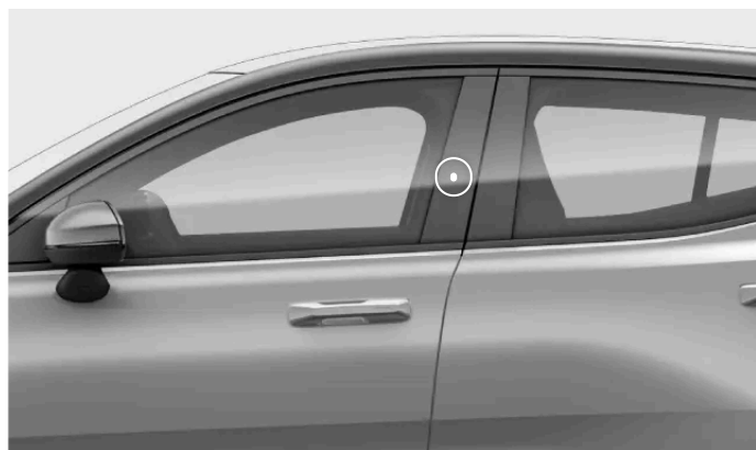
Nøglelæsningsplacering på førerdørstolpen.
