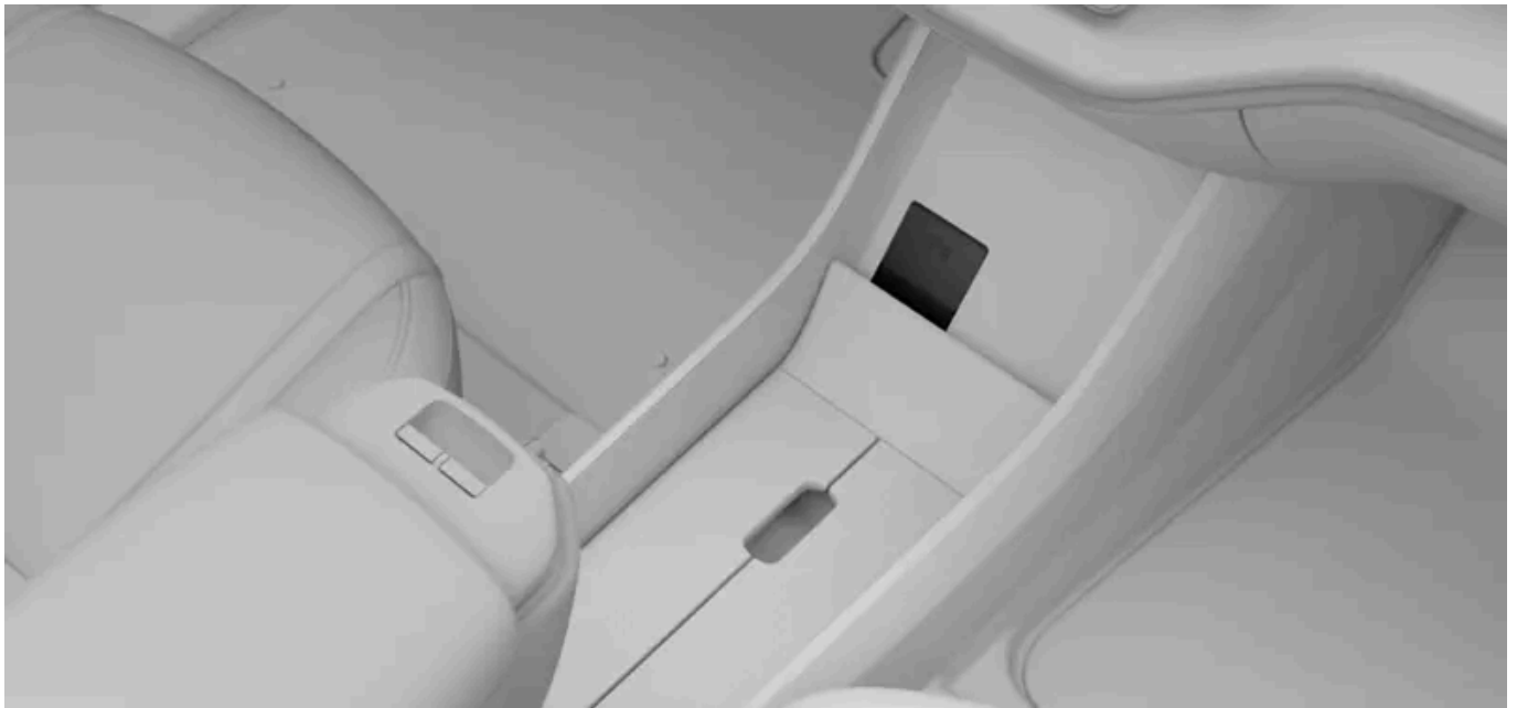
Den trådløse oplader under displayet
