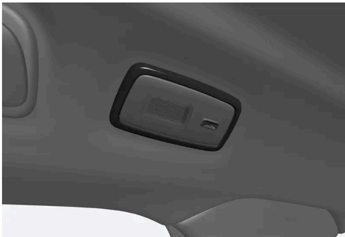
I bil med panoramatag* sidder de to lampeenheder i hver side af taget.
