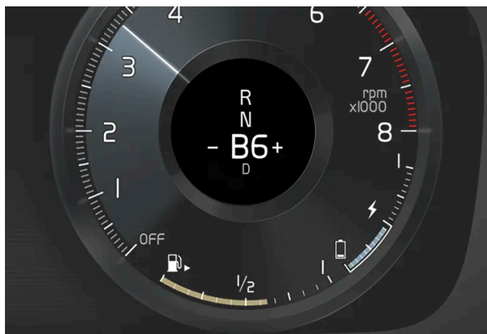
Gearskiftindikator på førerdisplayet [1] .
