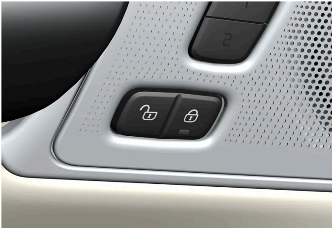
Låseknapper med indikeringslampe i fordør.
