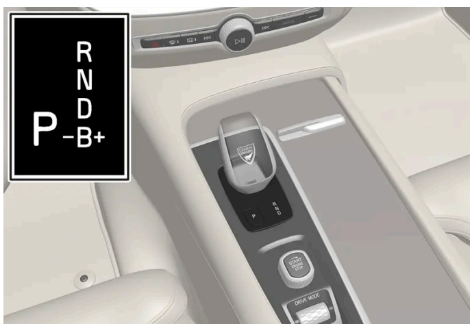
Oversigt over gearstang og gearskiftemønster på førerdisplay.
