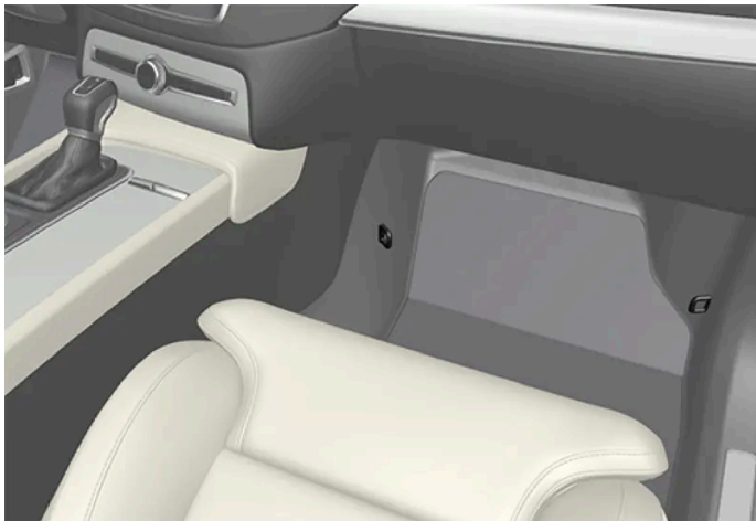
Befæstelsespunkternes placering på forsædet.
