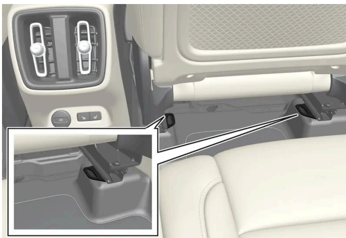
Befæstelsespunkternes placering på bagsædet.
