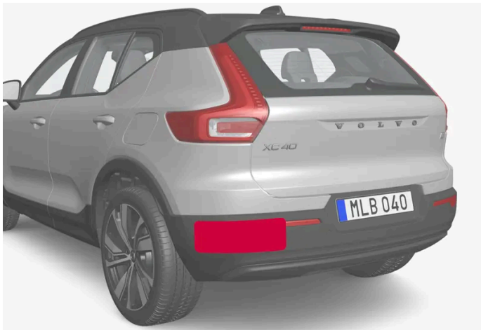
Placering af bageste radarenheder
