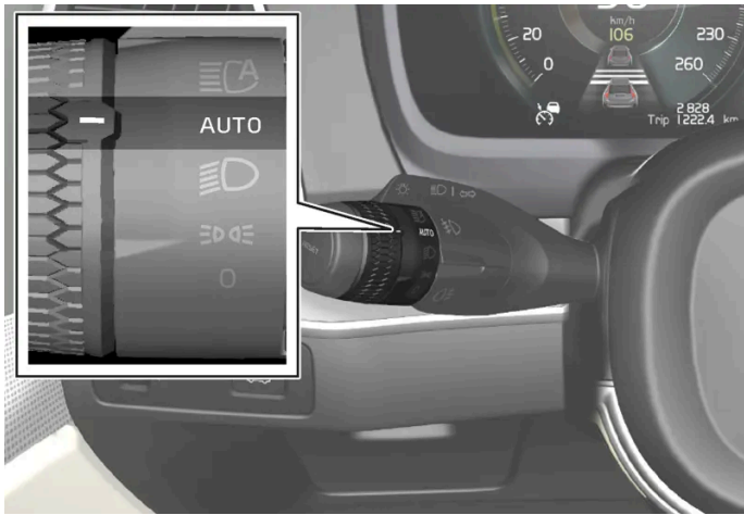
Kontaktarmens drejning i position AUTO .
