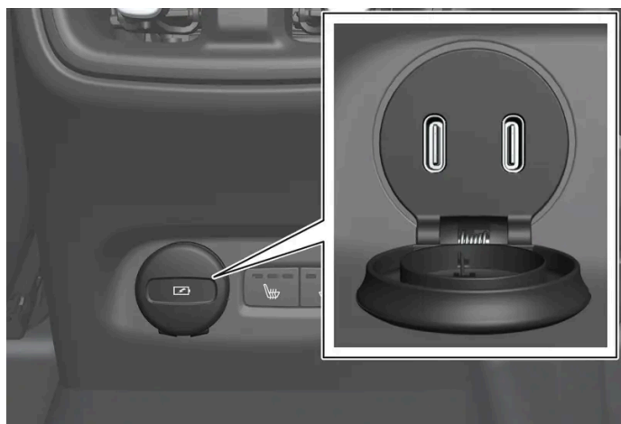
USB-porte (type C) i tunnelkonsol, bagsæde.
