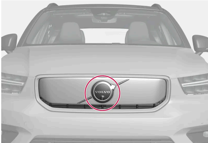
Placering af forreste radarenhed
