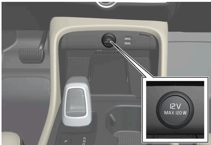
12 V-stikkontakt i tunnelkonsol, forsæde.
