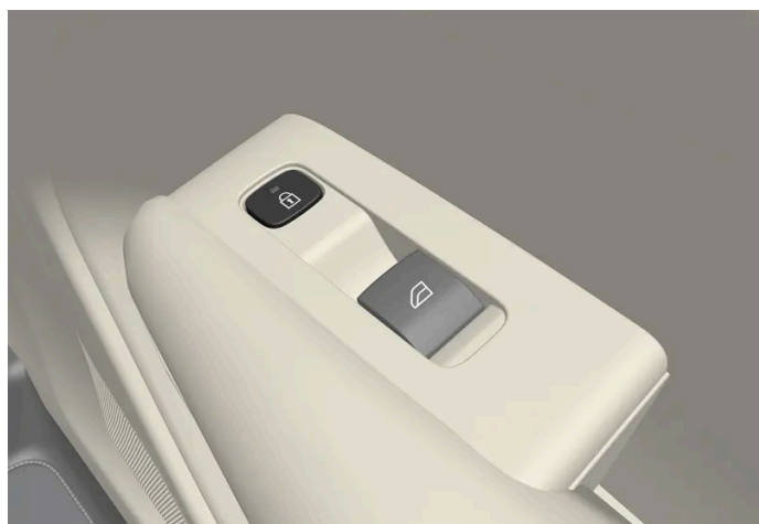
Låseknapp med indikeringslampe i bagdør.
