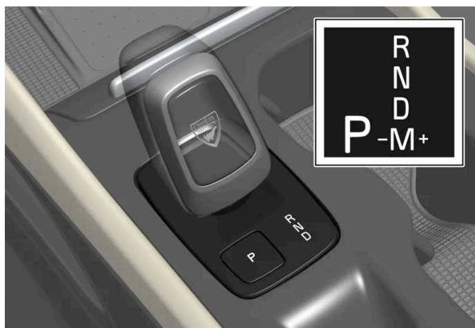
Oversigt over gearstang og gearskiftemønster på førerdisplay.
