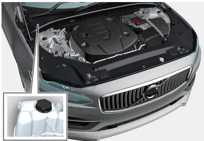
Ekspansionsbeholder for kølesystemet, højrestyret bil.
