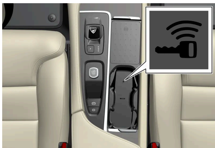
Backup-læserens placering i tunnelkonsollen.
