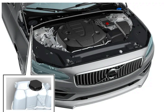
Ekspansionsbeholder for kølesystemet, venstrestyret bil.
