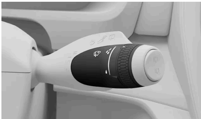
Betjeningselementerne til forrudeviskerne sidder på højre ratarm.
