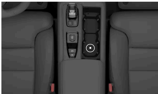
Placering af backup-læseren i tunnelkonsollens kopholder
