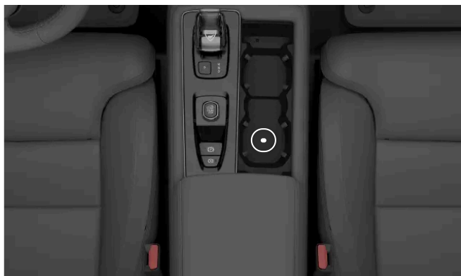
Placering af backup-læseren i tunnelkonsollens kopholder
