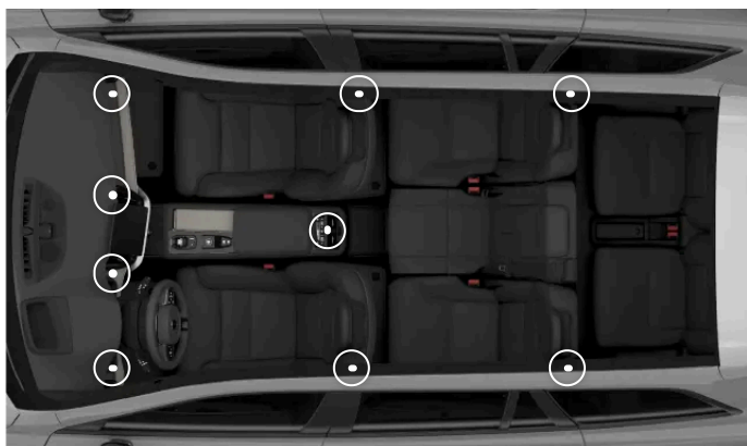
De justerbare luftdysers placering
