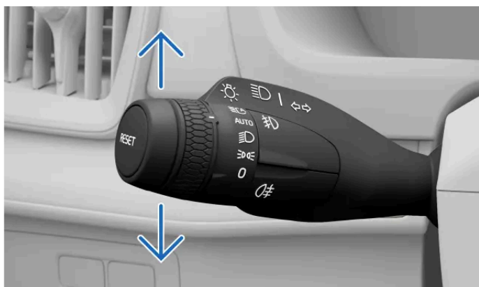
Los intermitentes de la palanca izquierda
